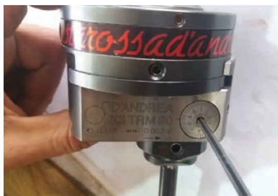
شکل ۲۰- جابه جایی به کمک ورنیه‌های روی ابزار
