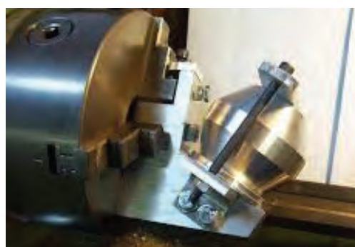
شکل ۳۵- فیکسچرهای تراش کاری
