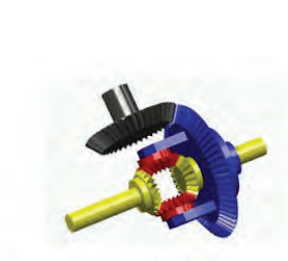
استفاده از چرخ دنده‌های مخروطی
