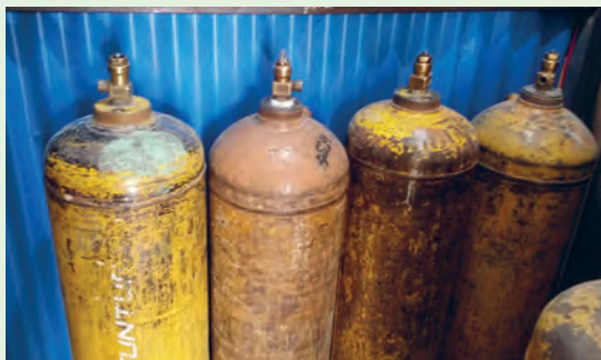
شکل ۱۶- کپسول های حاوی گاز استیلن
