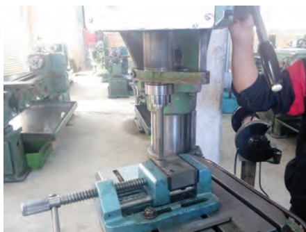
شکل ۱۳- نصب برقوروی محور دستگاه مته
