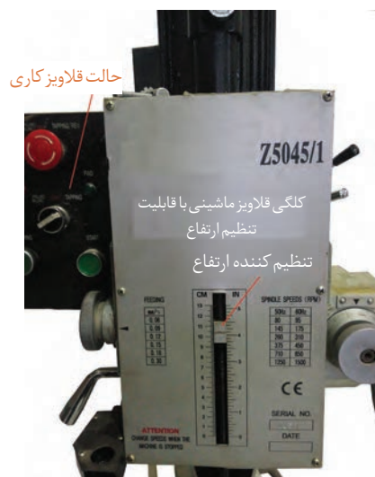
شکل ۴- کُلگی قلاویز ماشینی با قابلیت تنظیم ارتفاع
