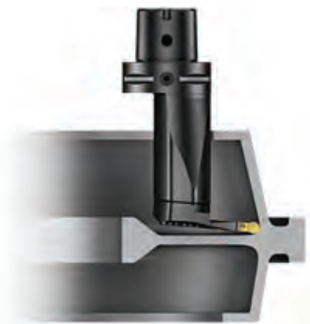
شکل ۶- ایجاد شیار در داخل سوراخ
