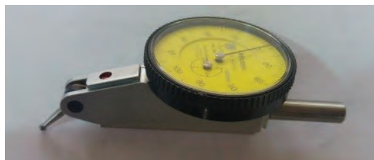
شکل ۲۵- ساعت حساس (شیطانی) برای کنترل دایره‌ای بودن
