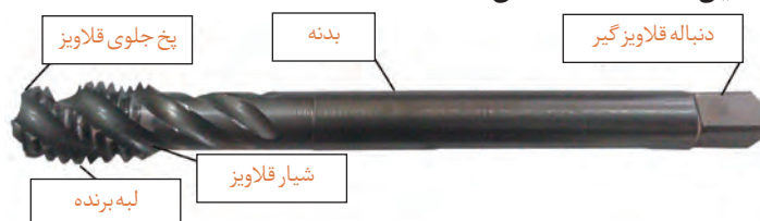
شکل ۲- ساختمان قلاویز ماشینی
