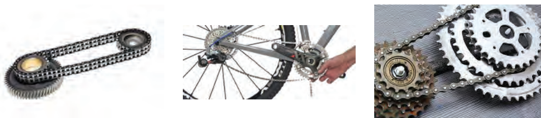
شکل ۲۱- مکانیزم‌های چرخ زنجیری
