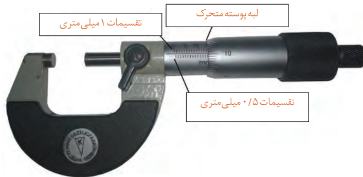
شکل ۲- میکرومتر با استوانه متحرک ۵۰ قسمتی
