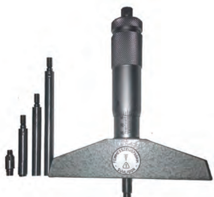
شکل ۴- میکرومتر عمق سنج
