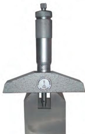
شکل ۵- اندازه گیری با میکرومتر عمق سنج
