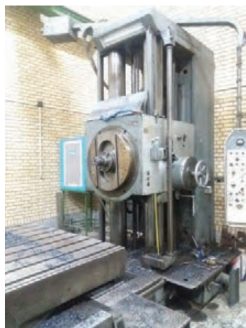
شکل ۱۰- دستگاه جیک بورینگ
