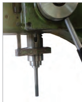
شکل ۱۳- نصب برقوروی محور دستگاه مته
