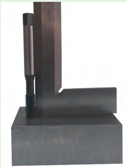
شکل ۷- کنترل عمود بودن قلاویز با سوراخ
