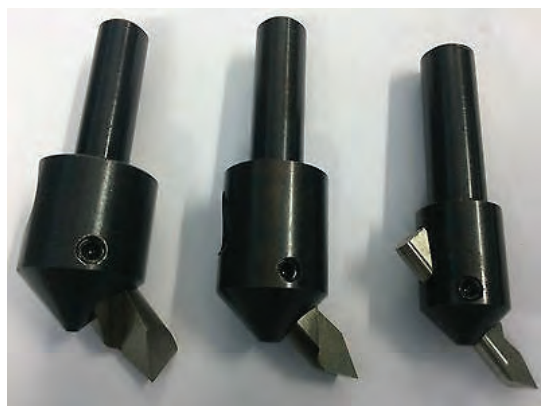
شکل ۱۱- ابزار داخل تراشی
