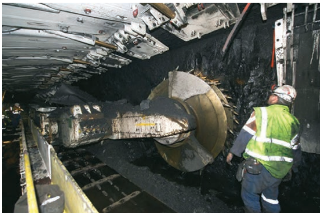
ماشین شیرر، ناو زنجیری، جک‌های هیدرولیکی متحرک در استخراج به روش جبهه کار طولانی مکانیزه
