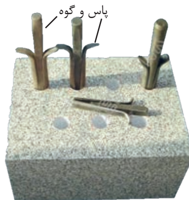
پاس و گوه و انجام عملیات چکش کاری جهت برش سنگ
