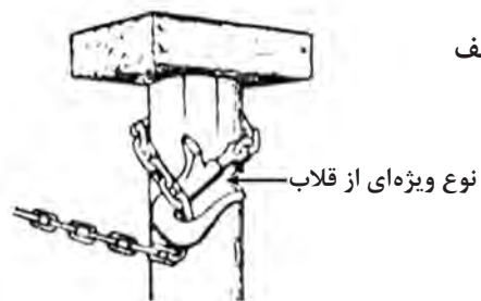
الف) نحوه بستن قلاب به دور پایه
