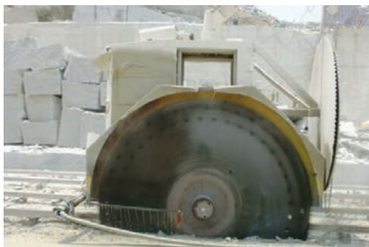
دستگاه دیسک برنده در حال برش سنگ
