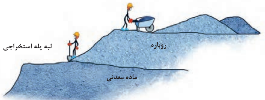
نحوه برداشت روباره در معادن روباز
