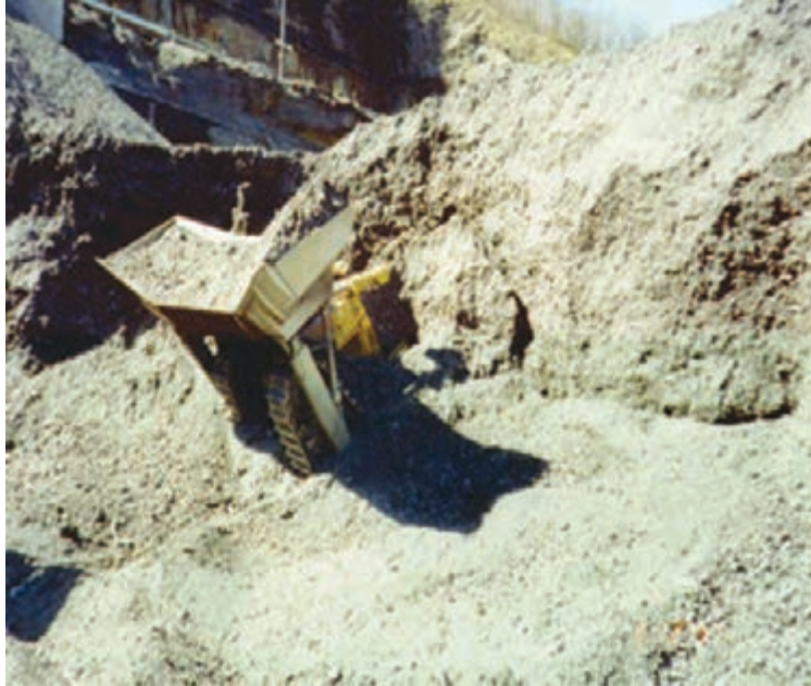
ریزش خاک‌های نرم بر روی ماشین معدنی
