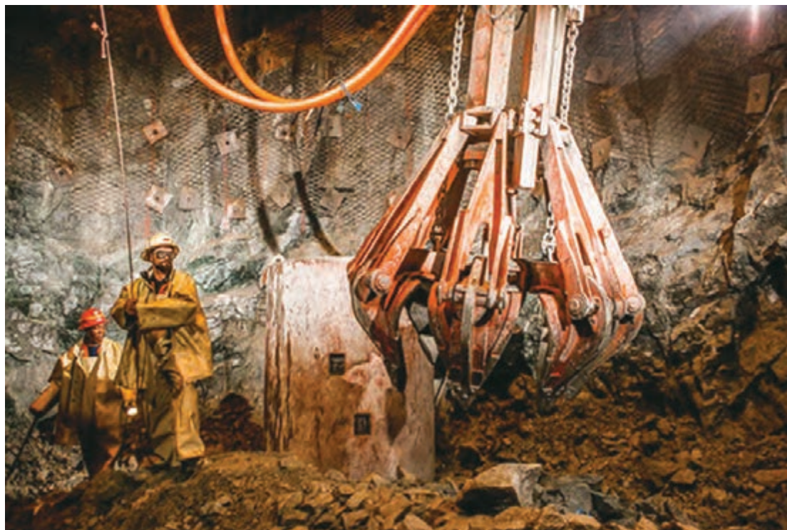
تصور بارگیری و حمل مواد معدنی از طریق چاه اصلی توسط بالابر
