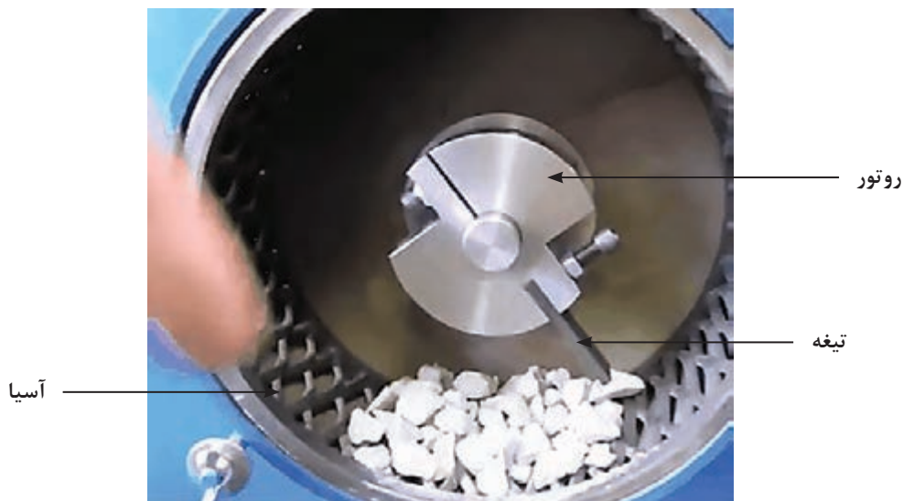
شکل ۳- نمای داخلی آسیای استاندارد ساینده‌گی باند
