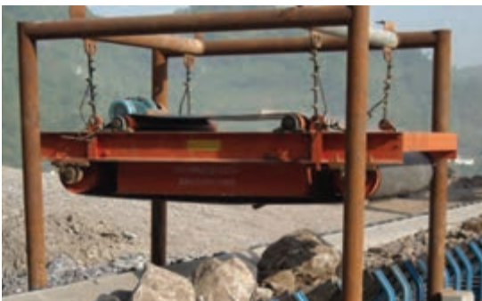
شکل ۲۶- جدا کننده های مغناطیسی معلق نوار متقاطع
