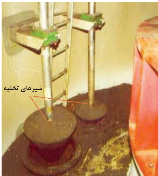
محل قرارگیری سطح سنج مکانیکی در یک سلول فلوتاسیون محل قرارگیری شیرهای تخلیه درون یک سلول (کف سلول)
