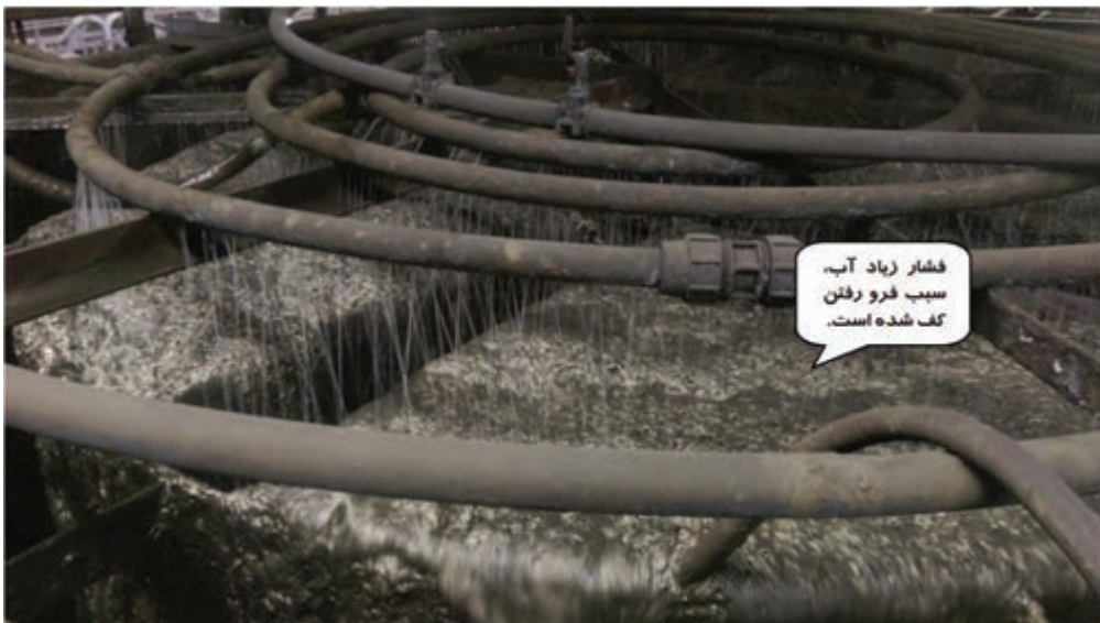
شکل ۴۲- تأثیر فشار آب در فرو رفتن کف در سطح سلول فلوتاسیون
