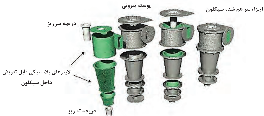
شکل ۲۱- اجزاء تشکیل دهنده سیکلون
