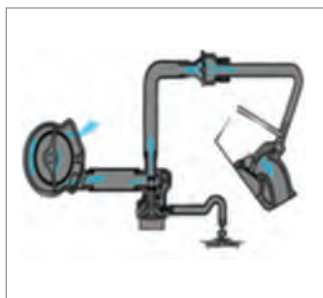
پمپ تزریق ثانویه اسماگ
