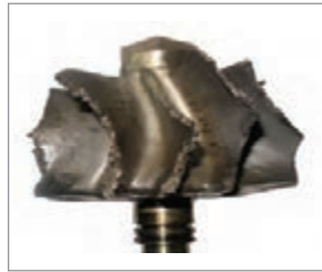
شکل ۸۲- خرابی پره های توربوشارژر در اثر برخورد با جسم خارجی
