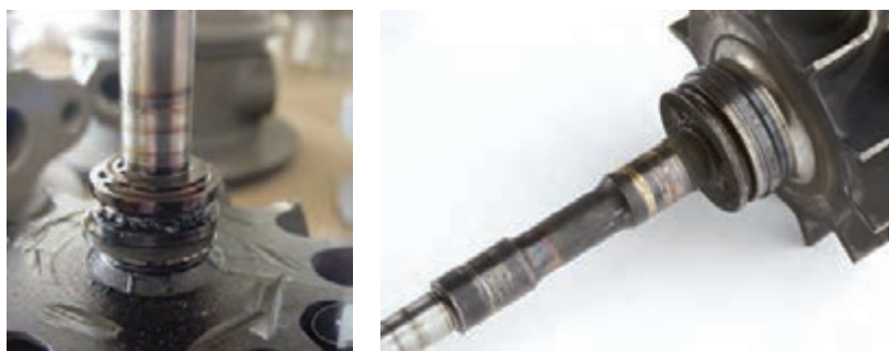
شکل ۸۵- خرابی یاتاقان‌ها و محور توربوشارژر
