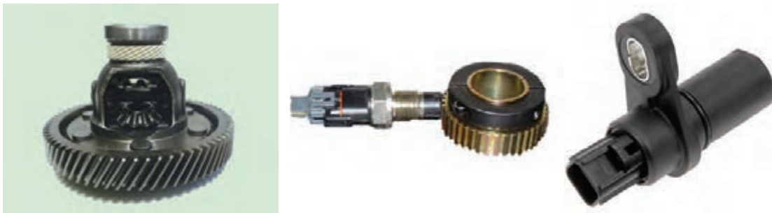
شکل ۵۸- حسگر و چرخ‌دنده بسته شده روی دیفرانسیل
