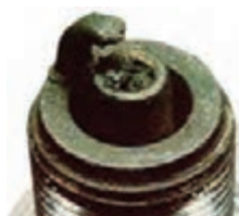
شکل ۳- آسیب به شمع بر اثر خودسوزی
