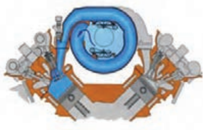
شکل ۴۱- عملکرد سیستم TUMBLE
