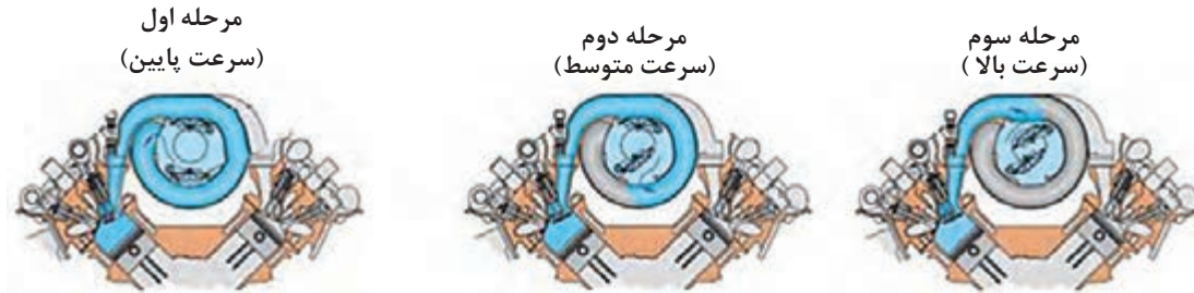
شکل ۴۲- عملکرد سیستم TUMBLE
