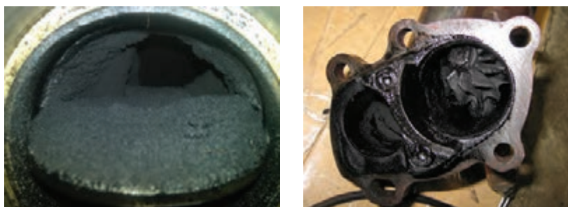
شکل ۸۴- رسوب کربن در ورودی و خروجی توربوشارژر
