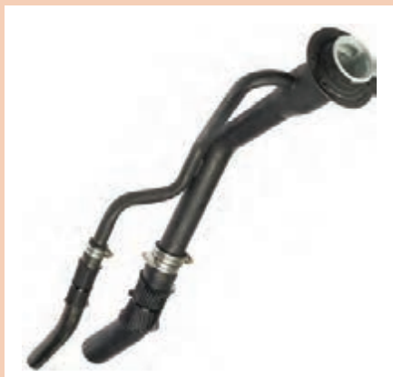
شکل ۳۷- لوله فلزی ورودی و مجرای کناری
