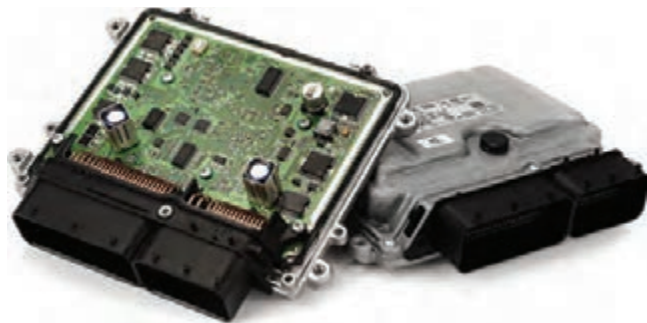
شکل ۱۹- یک نوع واحد کنترل الکترونیکی
