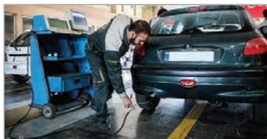
شکل ۶۵- قرارگیری لوله دستگاه کنترل آلاینده‌گی روی لوله اگزوز
