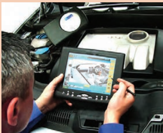
شکل ۷۵- نصب انژکتور الکترومکانیکی جدید توسط دستگاه عیب‌یاب
