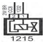
شکل ۵- نماد سوپاپ برقی کنیستر در نقشه‌ها
