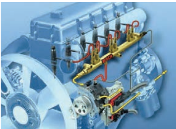
شکل ۶۴ - اجزای سیستم سوخت‌رسانی ریل مشترک
