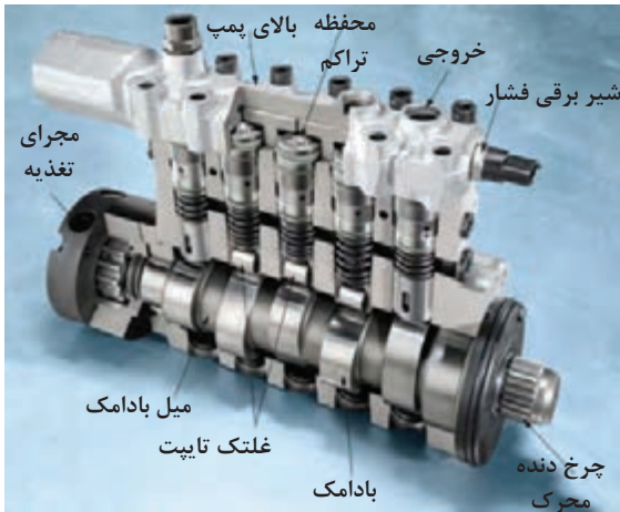
شکل ۲- یک نمونه پمپ انژکتور ردیفی
