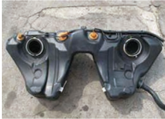
شکل ۷- مخزن سوخت با سوپاپ واژگونی
