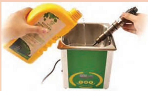
شکل ۷۸- تمیز کردن سوراخ انژکتور با دستگاه اولتراسونیک
