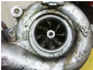
شکل ۸۲- خرابی پره های توربوشارژر در اثر برخورد با جسم خارجی
