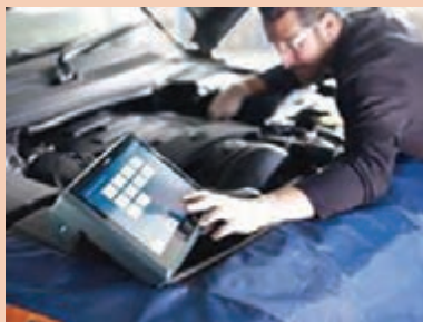
شکل ۵۲- استفاده از دستگاه عیب‌یاب
