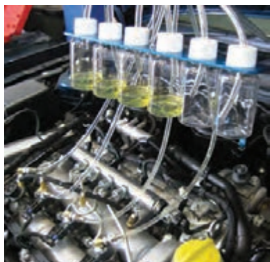
شکل ۵۵- تست اندازه‌گیری مقدار سوخت برگشتی انژکتورها
