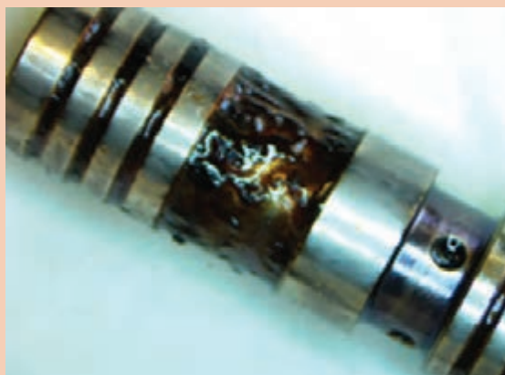
شکل ۷۶- خرابی انژکتور در اثر آب در سوخت
