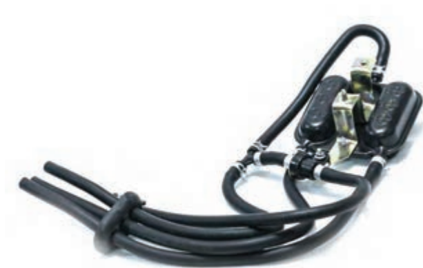
شکل ۶- ساختمان سیستم حباب‌گیر بنزین
