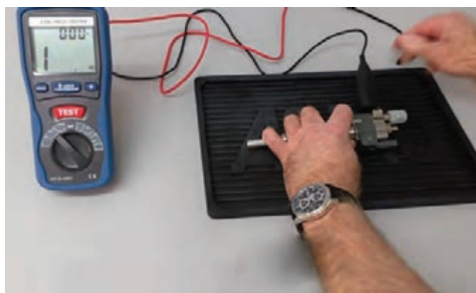
شکل ۷۹- تست مقاومت داخلی انژکتور
