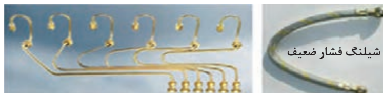
لوله‌های فشار قوی
