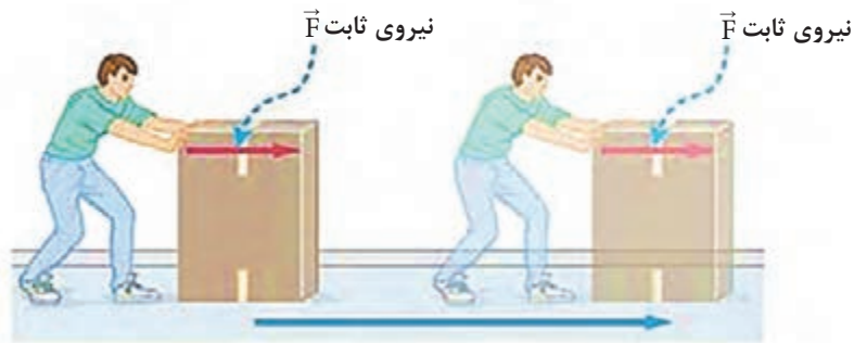
شکل ۵- انجام کار W برای جابه‌جایی جعبه به مسافت d
