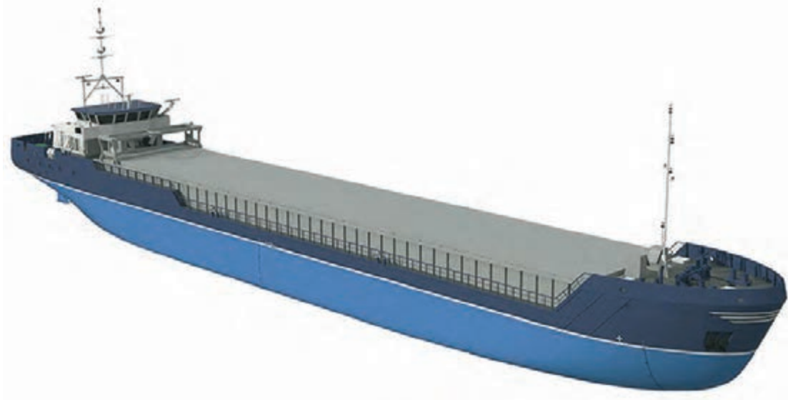
شکل ۱۰- سطح خیس شده شناور (ناحیه آبی‌رنگ)
