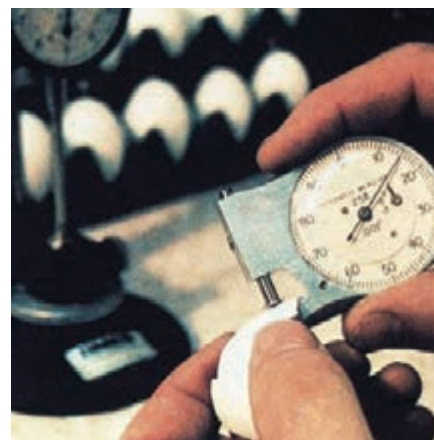
تصویر ۱-۲۵ - اندازه‌گیری ضخامت پوسته با میکرومتر
