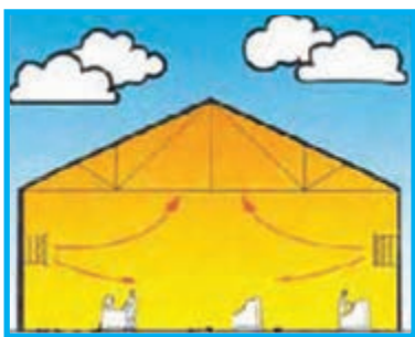
تصویر ۱-۲- مقایسه‌ی سیستم‌های گرمایشی جابه‌جایی و تابشی
