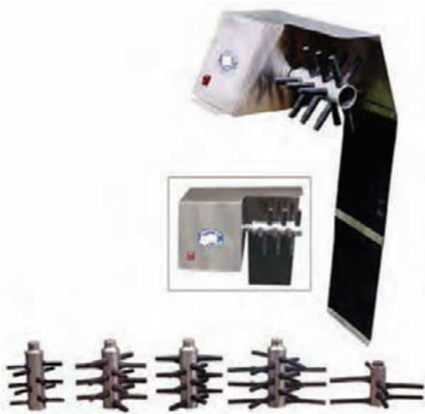
تصویر ۱۸-۸- انگشتانه‌ی پلاستیکی و محور دَوَران‌کننده در دستگاه پرکن
