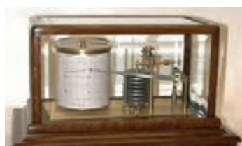
شکل ۳- دستگاه فشارنگار
