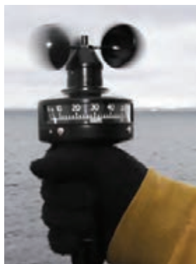
شکل ۱۵- بادسنج دستی
