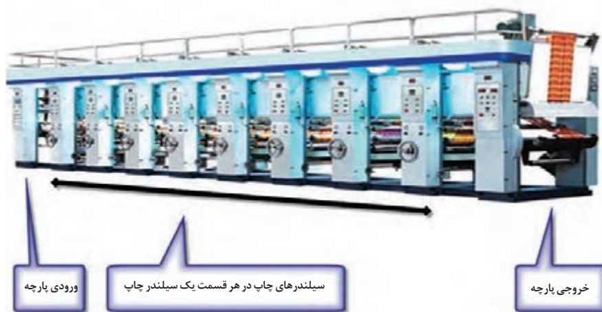
شکل ۸- نمای عملکرد ماشین چاپ غلتکی افقی
