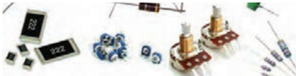
انواع مقاومت ثابت
