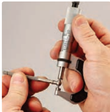
الف) اندازه‌گیری قطر یک قطعه توسط ریزسنج (میکرومتر)
