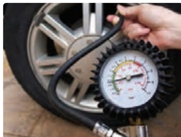
ب) اندازه‌گیری فشار هوای درون لاستیک خودرو
