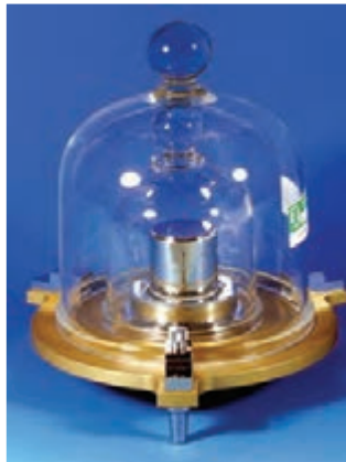
شکل ۶-۱ استاندارد کیلوگرم فلزی از جنس پلاتین- ایریدیوم می‌باشد که به‌صورت قراردادی جرم آن را معادل ۱ کیلوگرم تعریف کرده‌اند.
