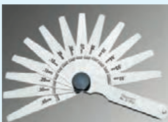
شابلون فیلر (اندازه گیری شکاف‌ها و شیارها)
