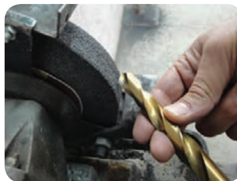
تیز کردن مته با دست و سنگ دو طرفه
