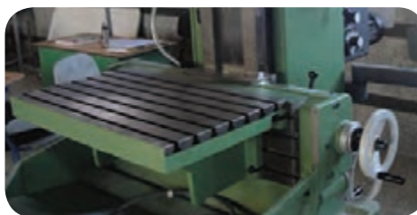
میز ماشین فرز و سیستم حرکتی آن
