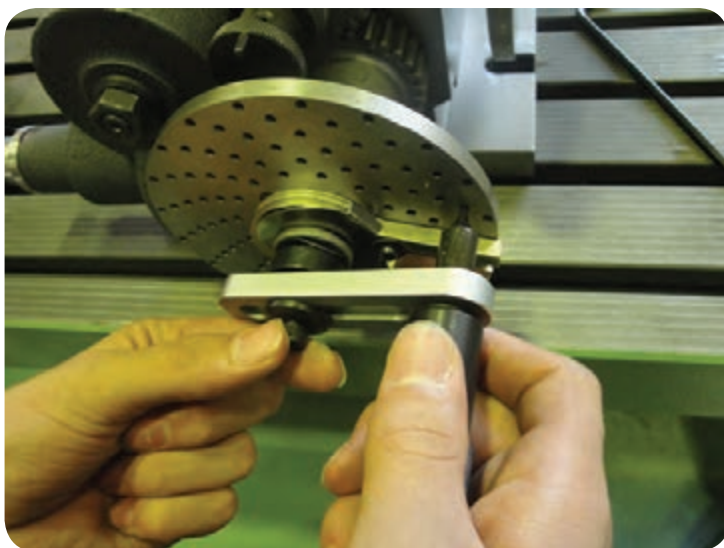
صفحه سوراخ‌دار و قیچی نصب بر روی دستگاه تقسیم
