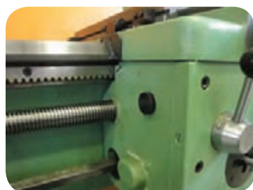
کاربرد چرخ و شانه در ماشین‌های تراش
