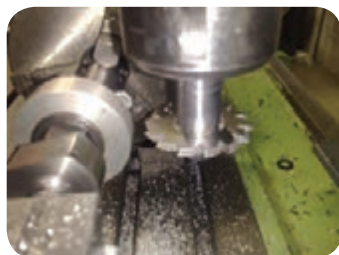
استفاده از ماشین فرز عمودی و میله فرزگیر یکطرفه در ساخت چرخ‌دنده مارپیچ
