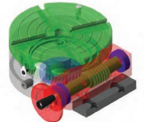
نمایش سیستم داخلی میزگردان
