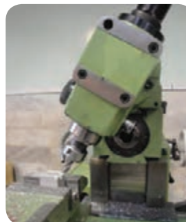
انحراف کله‌گی در صورتیکه از ماشین فرز عمودی برای چرخ‌دنده مارپیچ استفاده شود
