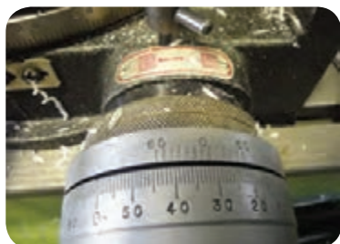
حلقه مدرج دستگیره میزگردان برای جابجایی دقیق‌تر
