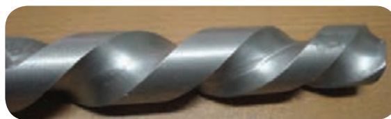
ایجاد شیار مارپیچ در یک میله گرد
