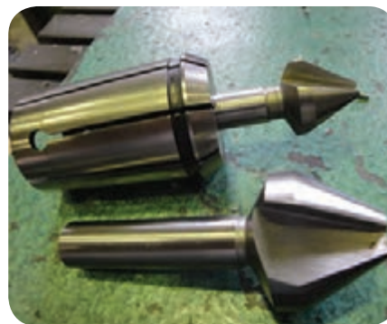
برای ایجاد خزینه راست گوشه ۱ از ابزارهای زیر می‌توان استفاده کرد.
