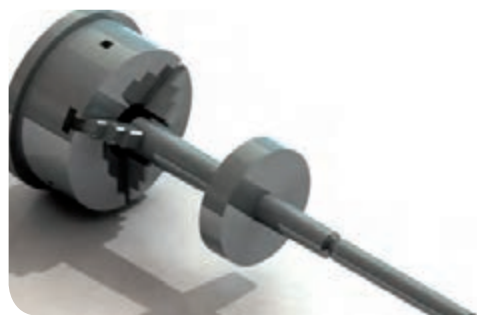
سوار کردن درن بر روی دستگاه تقسیم
