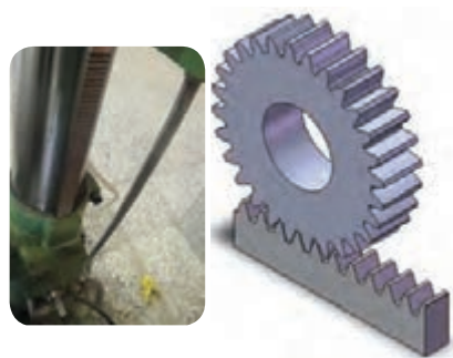
کاربرد چرخ و شانه در ماشین‌های مته
