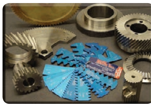
استفاده از شابلن در کنترل دندهی چرخ دنده
