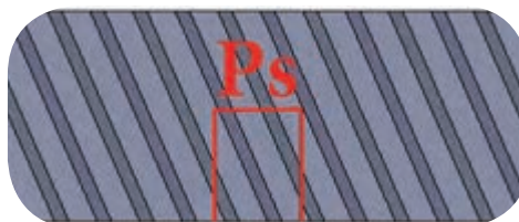
معرفی گام ظاهری در چرخ‌دنده شانه‌ای مایل
