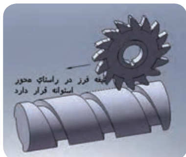
موقعیت اولیه قرارگیری تیغه فرز نسبت به قطعه کار قبل از فرزکاری
