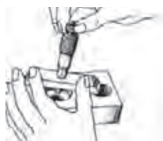
کنترل عمق سوراخ با استفاده از میکرومتر
