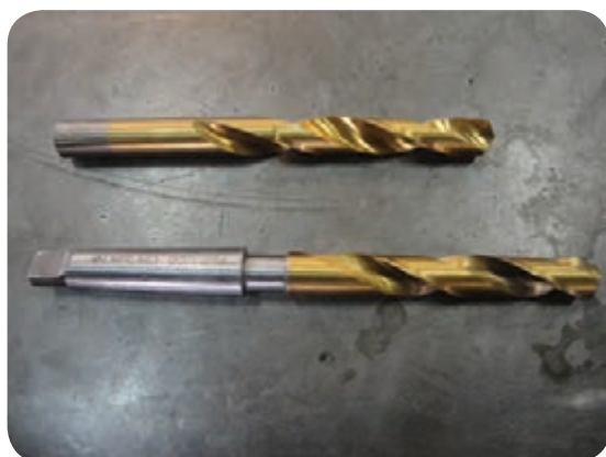
دنباله استوانه‌ای و مخروطی در مته‌ها
