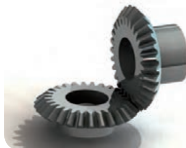
درگیری دو چرخ دنده مخروطی با یکدیگر
