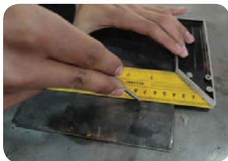
رعایت زاوایی تمایل سوزن خط‌کش
