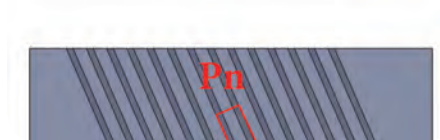
معرفی گام نرمال در چرخ‌دنده شانه‌ای مایل
