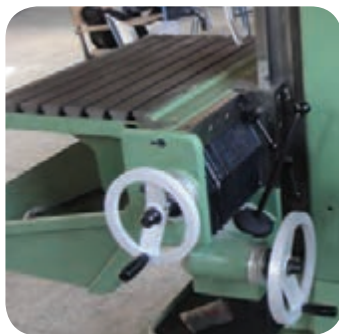
مکانیزم جابجایی میز ماشین
