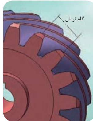
نمایشی گام نرمال در چرخ‌دنده مارپیچ
