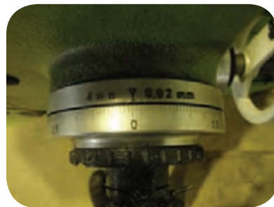
صفر کردن ورنیه دستگاه
