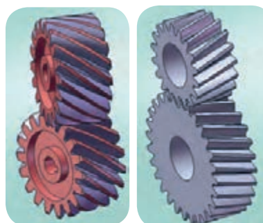
انتقال دور در دو محور متناظر با چرخ‌دنده‌های مارپیچ
