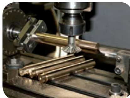
بستن تیغه فرز انگشتی خاص برای ایجاد شیار در قطعه
