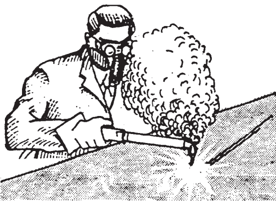
شکل ۱-۳۰- در موقع برشکاری روی سطوح گالوانیزه و رنگ شده از ماسک تنفسی استفاده کنید.
