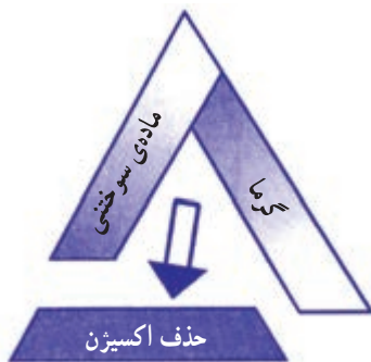
شکل ۱۶-۱-ممانعت از رسیدن اکسیژن به ماده‌ی سوختنی
