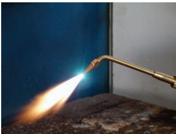
شکل ۲-۳- شعله‌ی سوختن گاز استیلن با اکسیژن
