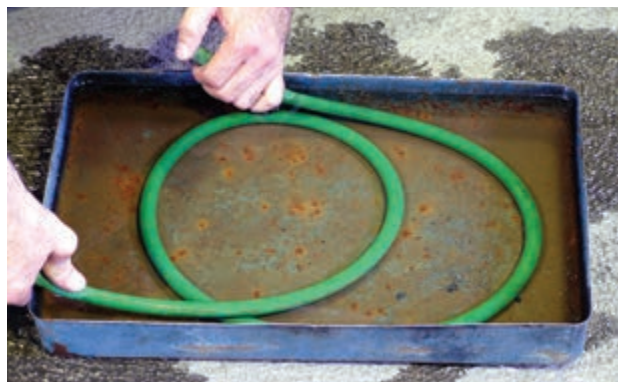
شکل ۲-۹۹ – کنترل نشتی شیلنگ در آب
