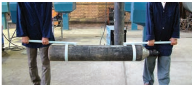
شکل ۸۶-۲- روش درست جابه‌جا کردن کپسول
