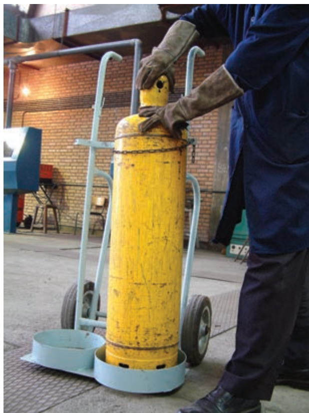
شکل ۱۹-۲- کپسول استیلن و کلاهک آن
