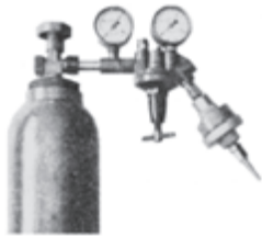
شکل ۲-۴۴- شیر یک طرفه بعد از رگولاتور
