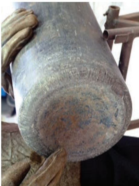
شکل ۱۸-۲- گودی ته کپسول اکسیژن
