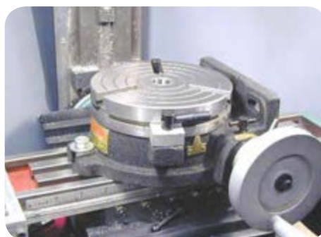
زاویه دار کردن قطعه با استفاده از میز گردان
