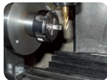
چهارگوش کردن قطعه به کمک دستگاه تقسیم
