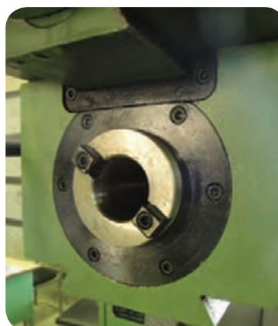
تمیز کردن گلوبی قبل از بستن میله فرز گیر
