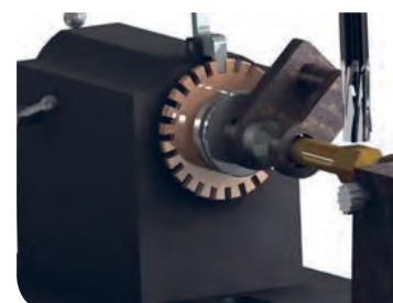
نحوه چند وجهی کردن قطعه با دستگاه تقسیم مستقیم
