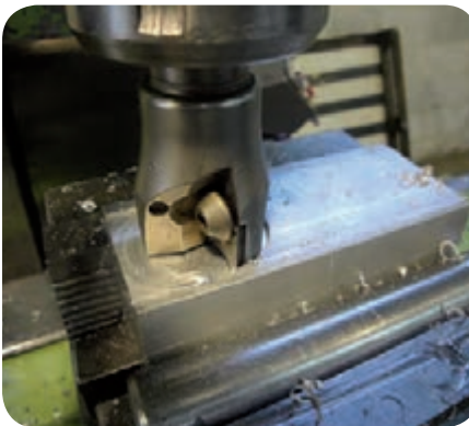
نا مطلوب بودن سطح قطعه به دلیل درگیری کل ابزار با قطعه کار
