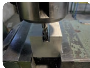
شیار تراشی با تیغه فرز انگشتی
