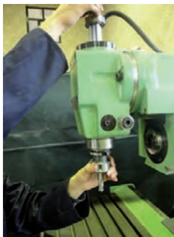
نحوه بستن کُلت بر روی دستگاه
