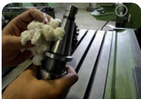
تمیز کردن دنباله میله فرزگیر
