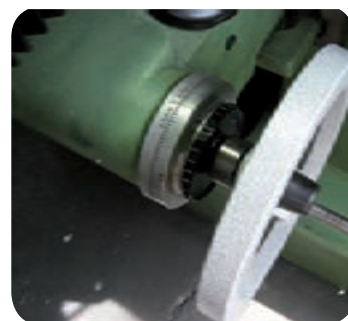
صفر کردن ورنیه های فلکه ها پس از مماس کردن ابزار با قطعه کار
