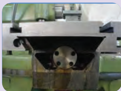
کاربرد شیاردم چلچله ای در سوپرت دستگاه
