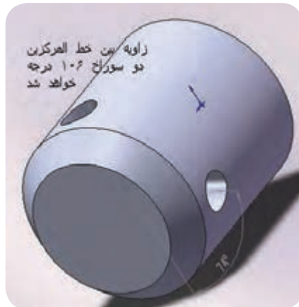
دو سوراخ بر روی محیط استوانه با زاویه ۱۰۶ درجه
