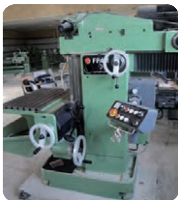
فلکه‌های دستگاه برای جابجایی دستی
