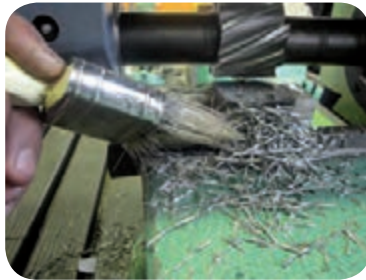
نحوه دور کردن براده ها
