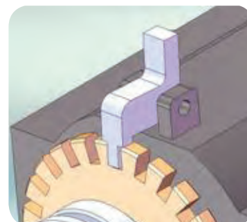
ضامن و شیار دستگاه تقسیم مستقیم در حالت ثابت
