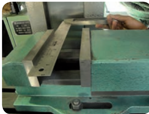
تنظیم فک‌های گیره با استفاده از گونیا
