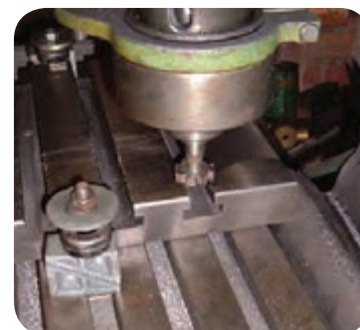
ایجاد شیار T شکل پس از ایجاد شیار راست گوشه
