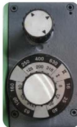
فلکه تنظیم پیشروی
