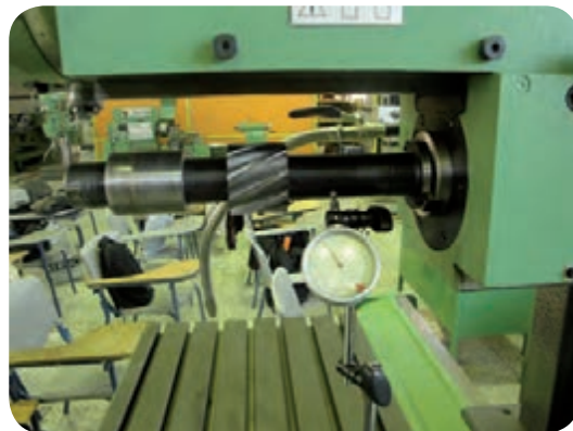
کنترل لنگی میله فرزگیر با ساعت اندازه گیری
