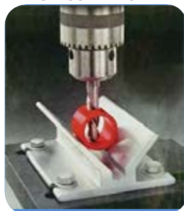
استفاده از شیار V شکل به عنوان تکیه گاه قطعات گرد
