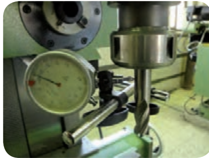
کنترل دور بودن تیغه فرز از لنگی با ساعت اندازه‌گیری
