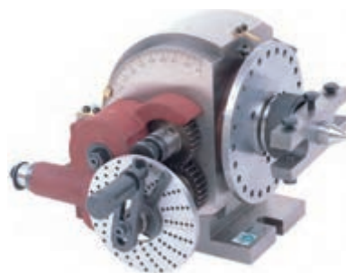
شیب دار کردن قطعه با استفاده از دستگاه تقسیم
