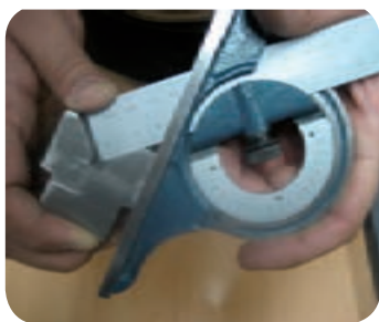
کنترل شیب قطعه با زاویه سنج انیورسال
