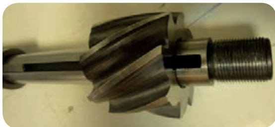
توجه به جهت گردش تیغه فرزها در هنگام نصب
