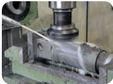
اعمال مایع خنک‌کننده بر سطح قطعه کار
