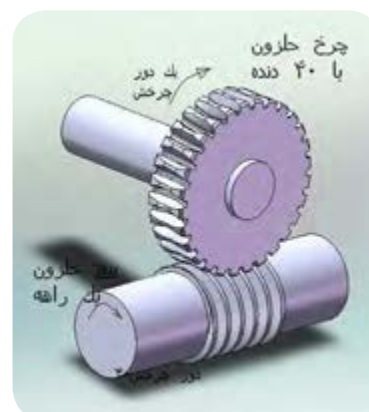
سیستم چرخ حلزون و پیچ حلزون
