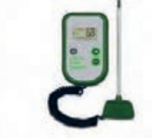
دستگاه اندازه‌گیری pH، حاصلخیزی و دمای خاک
