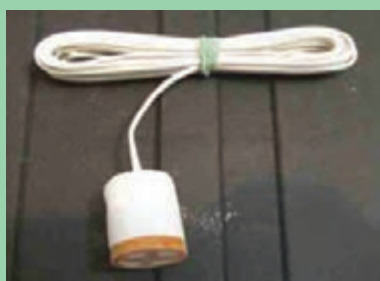
شکل ۵- نمونه بلوک گچی استوانه‌ای
