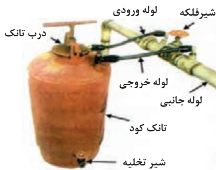
شکل ۲۸- اجزای سیستم توزیع کود
