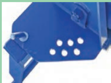
شکل ۱۳- صفحه سوراخ دار روی شاسی شانه خورشیدی
