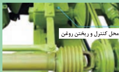
شکل ۶۳- جعبه دنده معکوس کننده
