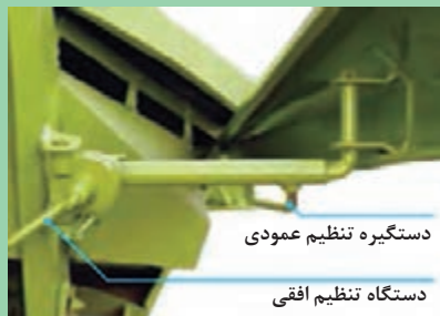
شکل ۵۰- دستگیره‌های تنظیم صفحه جداکننده محافظ علوفه
