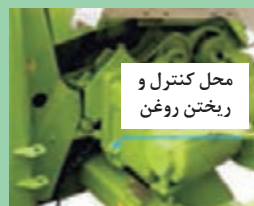
شکل ۶۵- جعبه دنده باردهی غلتک‌های تغذیه
