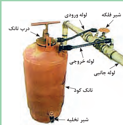
شکل ۳۳- اجزای سیستم توزیع کود
