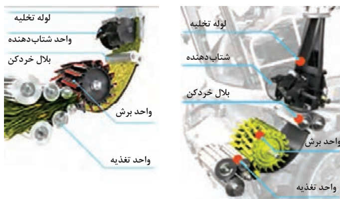
الف) موقعیت واحدها روی ماشین ب) حرکت علوفه در واحدهای ماشین
