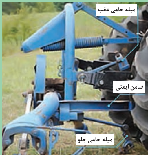
شکل ۲۱- نحوه اتصال دروگر شانه‌ای به تراکتور
