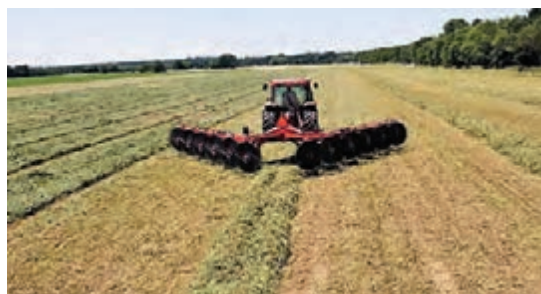
شکل ۸- شانه چرخ دوقلو با چرخ های یکپارچه
