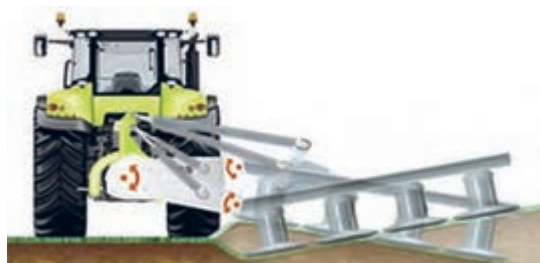
شکل ۱۲- حالت‌های کاری دروگر استوانه‌ای در شیب
