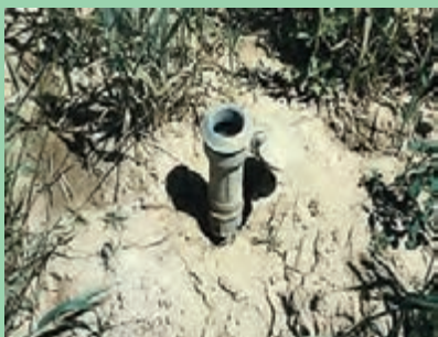
شکل ۱۲- شیر خودکار، رایزر و آبیاش
