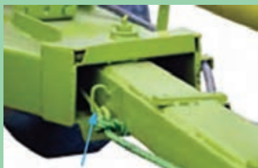
شکل ۷۰- طناب آزادکننده پین
