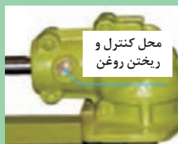
شکل ۶۶- جعبه دنده زانویی تیغه درو
