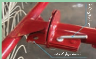
شکل ۱۳- صفحه سوراخ دار روی شاسی شانه خورشیدی
