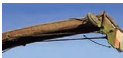
شکل ۵۸- حرکت عمودی کلاهک لوله تخلیه
