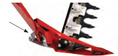
شکل ۳۱- کفشک تنظیم ارتفاع برش
