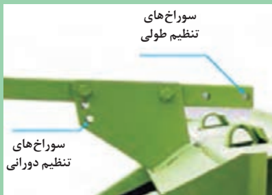
شکل ۵۱- هدایت کننده علوفه و پیچ‌های تنظیم آن
