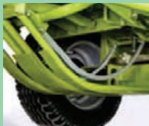
شکل ۱۴- محل قرارگیری نخ‌گیر، راهنمای نخ و سوزن‌ها
