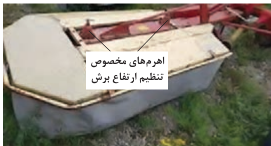
شکل ۲۸- اهرم‌های مخصوص تنظیم ارتفاع برش
