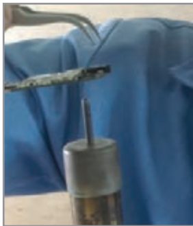
شکل ۲-۸ حرارت از زیر برد
