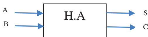
شکل ۲-۵ بلوک دیاگرام جمع کننده ناقص
