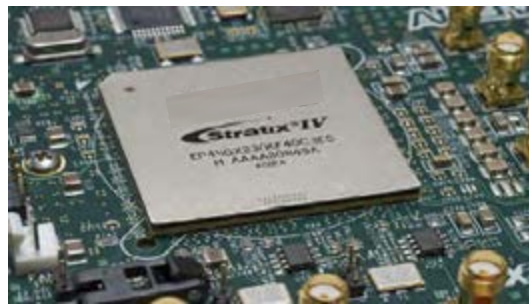
شکل ۲۳-۵ کاربرد آی‌سی FPGA در مدارهای پیشرفته
