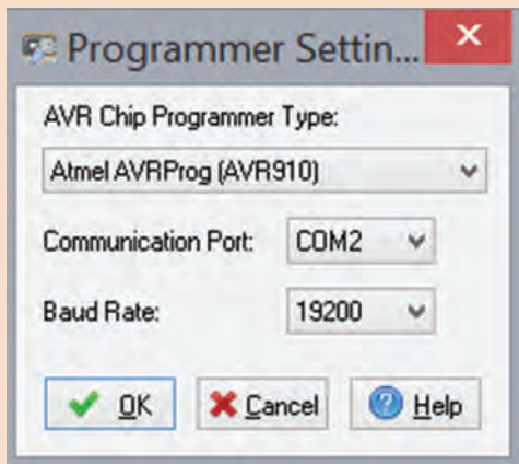
شکل ۷-۲۱ تنظیم پورت و سرعت پروگرامر AVR ۹۱۰
