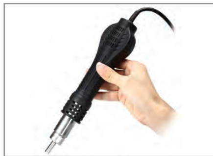
شکل ۷-۱ چگونگی صحیح در دست گرفتن هویه
