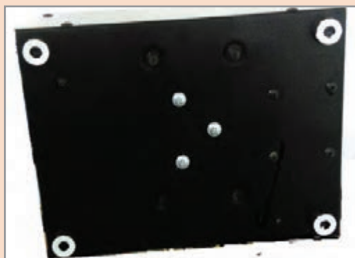
شکل ۱-۴ سه پیچ قفل کننده کمپرسور به بدنه
