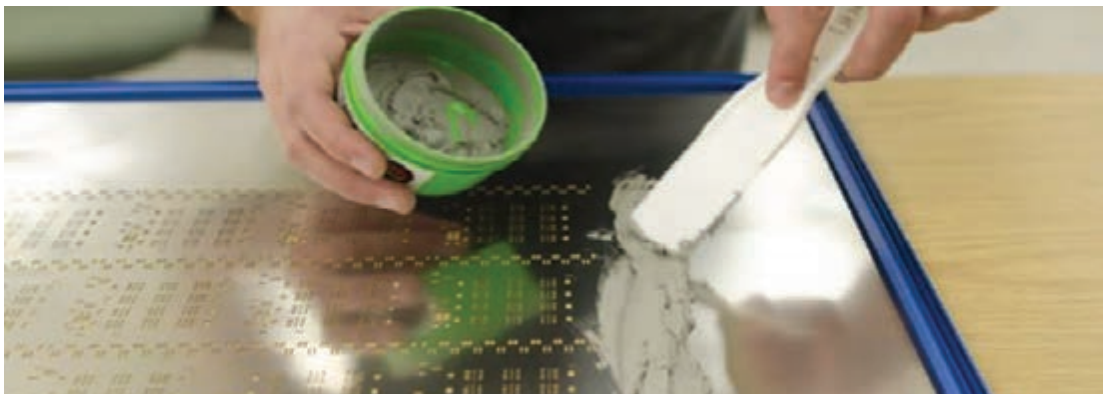
شکل ۱۲-۳ خمیر اندود کردن لحیم به کمک شابلون
