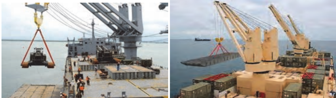
شکل ۱۲-۵- تخلیه و بارگیری کالا با استفاده از جرثقیل کشتی
