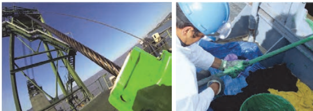
شکل ۲۲-۱ روان کاری طناب سیمی با گریس
