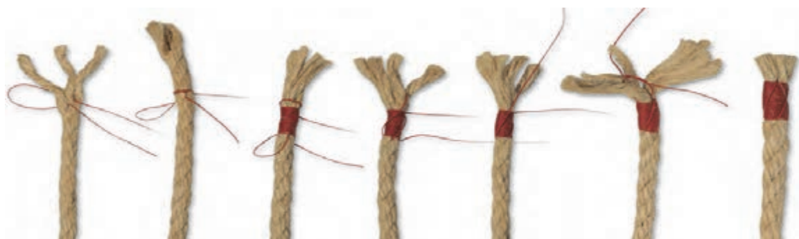
شکل ۲۱-۲- نخ‌پیچی کردن انتهای طناب
