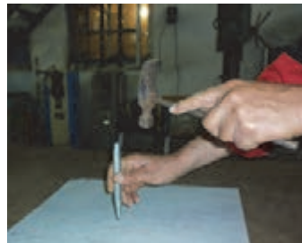
شکل ۱۳- استفاده از سنبه برای نشانه‌گذاری
