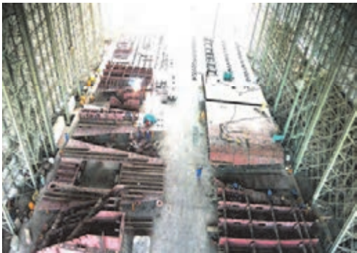
شکل ۵- جوش کاری بلوک کشتی
