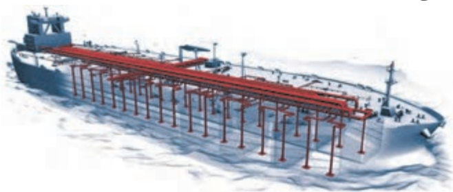
شکل ۲۱- خم کاری لوله در ساختمان یک نفتکش
