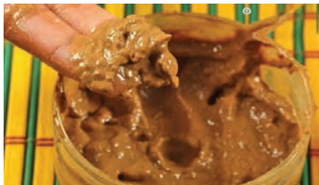
شکل ۵۵- بنتونیت آب جذب کرده و متورم شده
