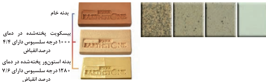
شکل ۵۱- انقباض و متراکم شدن بدنه
