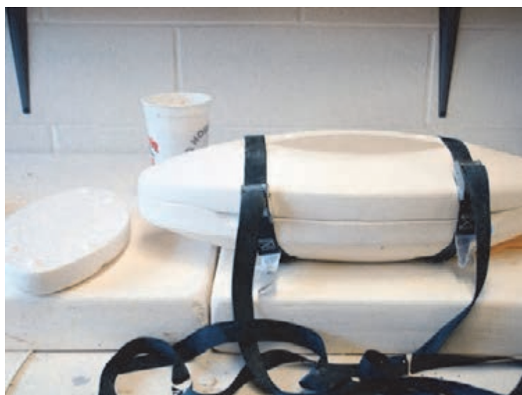
شکل ۱۵- روش‌های مختلف بستن قالب
