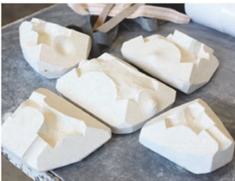
شکل ۴۸- قالب با زاویه‌های متعدد
