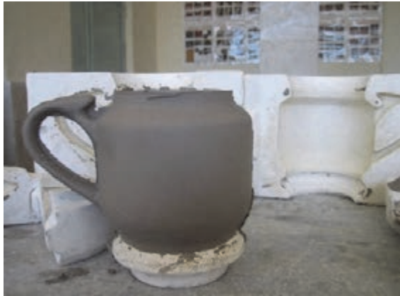
شکل ۴۲- شکل‌دهی جداگانه لوله و بدنه قوری
