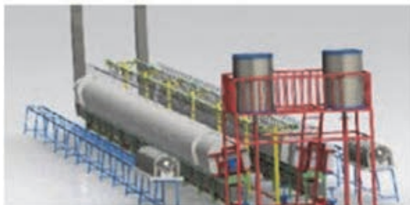
ب) قرار دادن مخزن دوغاب در ارتفاع
