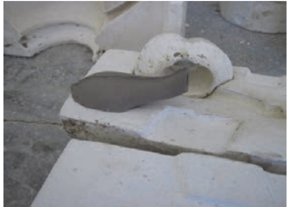
شکل ۴۲- شکل‌دهی جداگانه لوله و بدنه قوری
