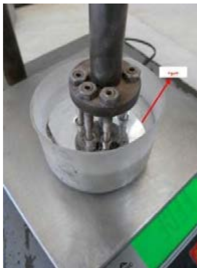
شکل ۱۵- محاسبه حجم به روش غوطه‌وری نمونه در جیوه
