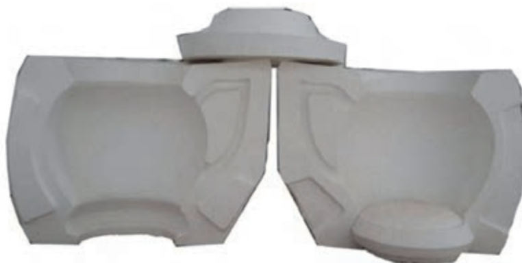
شکل ۲۶- قالب بدنه‌ی یک قوری
