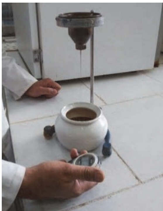
شکل ۱۶- اندازه‌گیری گرانروی دوغاب
