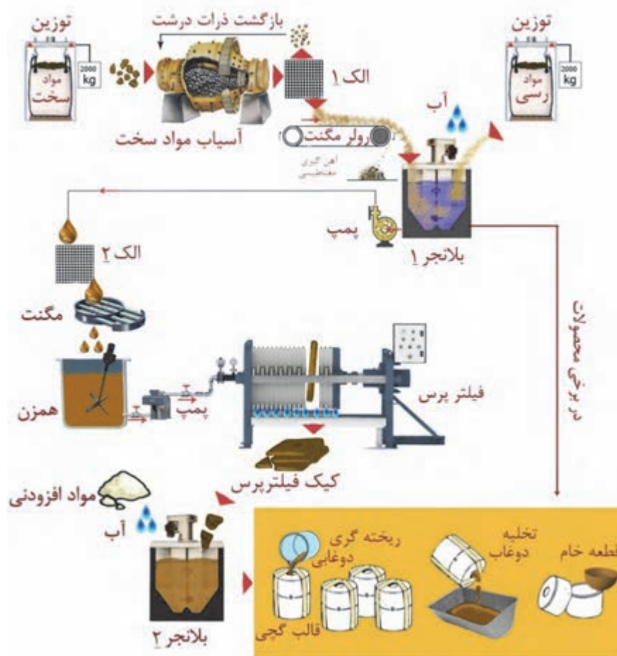
شکل ۱۱- فرایند ساخت دوغاب و شکل‌دهی قطعه
