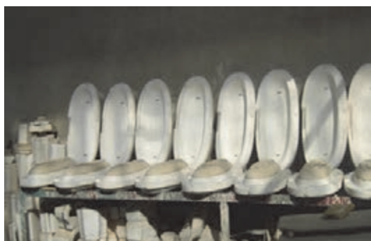
شکل ۲۸- باز کردن قالب
