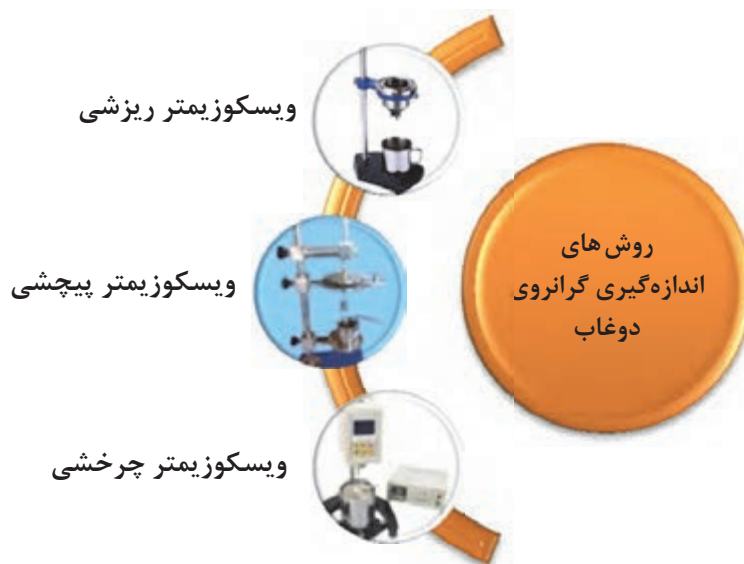
شکل ۷- روش‌های اندازه‌گیری گرانروی دوغاب
