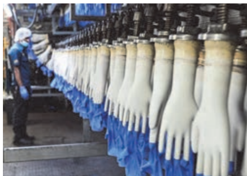
شکل ۱- قالب مورد استفاده در تولید دستکش
