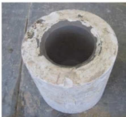
شکل ۹- قالب نمونه برای تعیین سرعت ریخته‌گری
