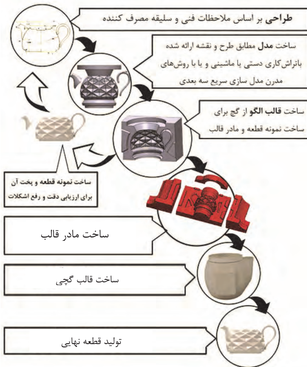
شکل ۶- مراحل ساخت قطعه سرامیکی
