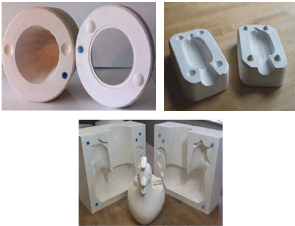
شکل ۶- پین‌های انواع قالب
