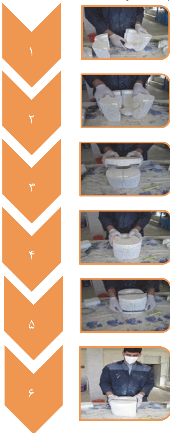
شکل ۷- مراحل بستن قالب
