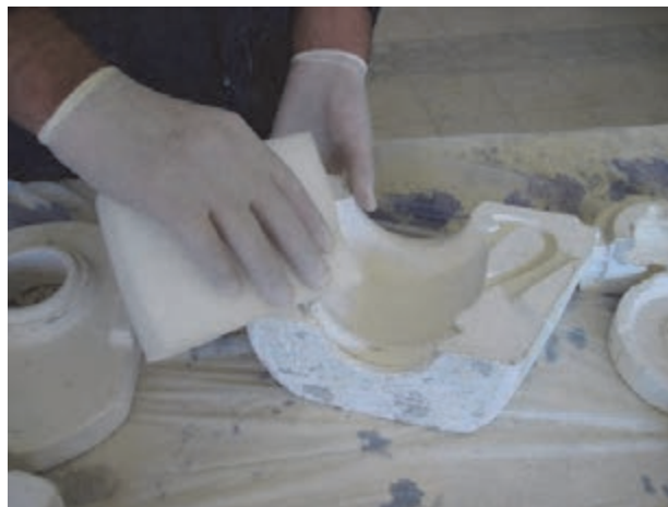
شکل ۴- زدودن گرد و غبار از قالب
