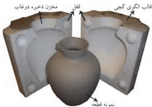
شکل ۱۵- قطعه ریخته‌گری شده در قالب الگو
