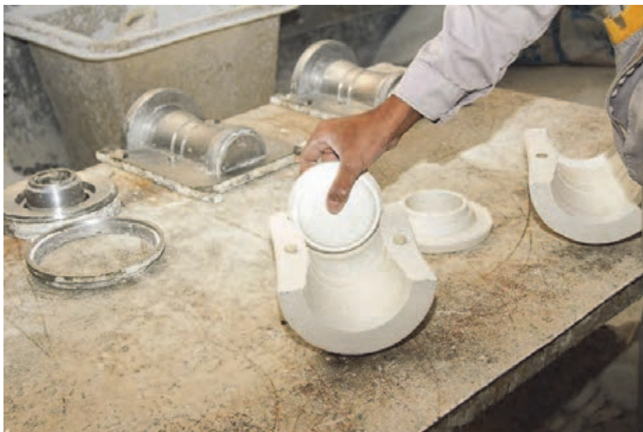
شکل ۵- یک قالب چند تکه
