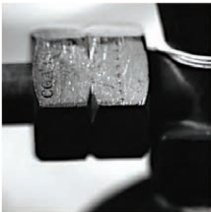
چپ‌گرد (شیر تنظیم گازهای اشتعال پذیر)
