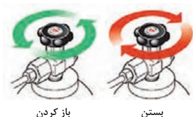
شکل ۸-۵- جهت باز کردن و بستن شیر کپسول گازی
