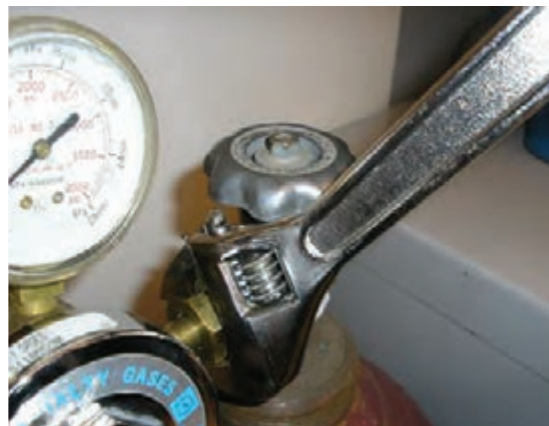
شیوه بستن شیر تنظیم به کپسول
