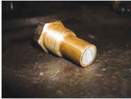
شکل ۳۳- مجرای ذوب شدنی روی شانه یک سیلندر گاز تحت فشار و یک مجرای ذوب شدنی مجزا قبل از نصب
