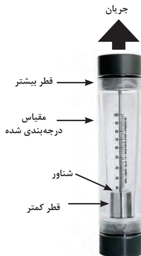
شکل ۷ - یک نمونه روتامتر معمولی
