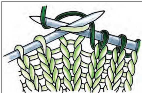
شکل ۲- نحوه تهیه بافت حلقوی پودی و نمونه بافته شده آن با دست
