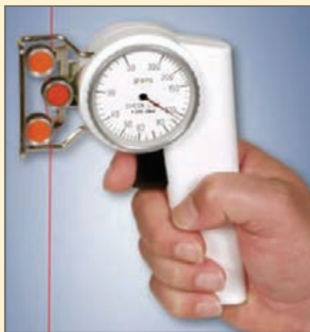
شکل ۶ - دستگاه اندازه‌گیری کشیدگی نخ
