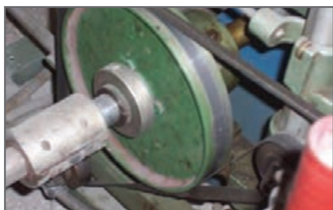
شکل ۱۸- پولی و تسمه انتقال حرکت
