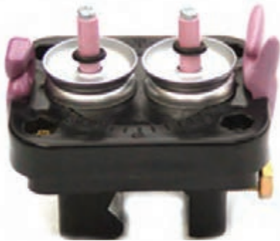
شکل ۳۶ - دستگاه کشیدگی نخ با صفحه و فنر
