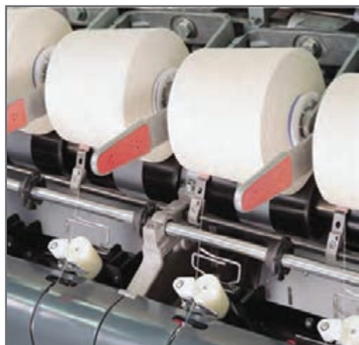
شکل ۲۵- راهنمای متحرک پیچش نخ (تراورس)
