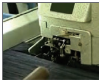
شکل ۳۱- دستگاه گره زن تار چله قدیم به تار چله جدید
