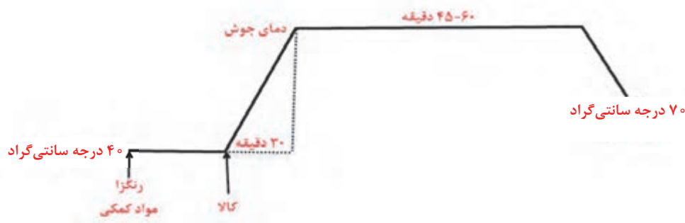
شکل ۳ تصویر نمودار رنگرزی نایلون با مواد رنگزای دیسپرس
