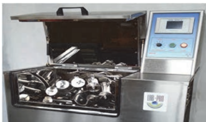
شکل ۲ یک عدد ماشین رنگرزی آزمایشگاهی تحت فشار
