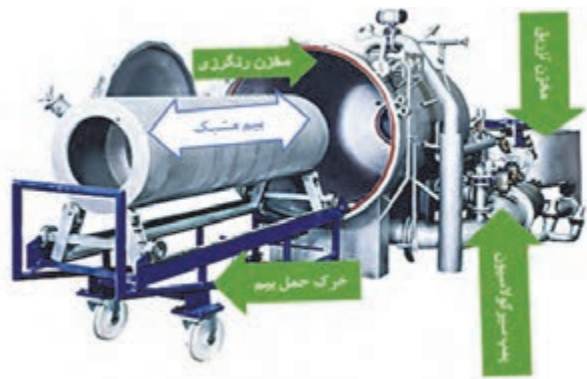
شکل ۱۲ تصویر قسمتهایی از ماشین رنگریزی بیم
