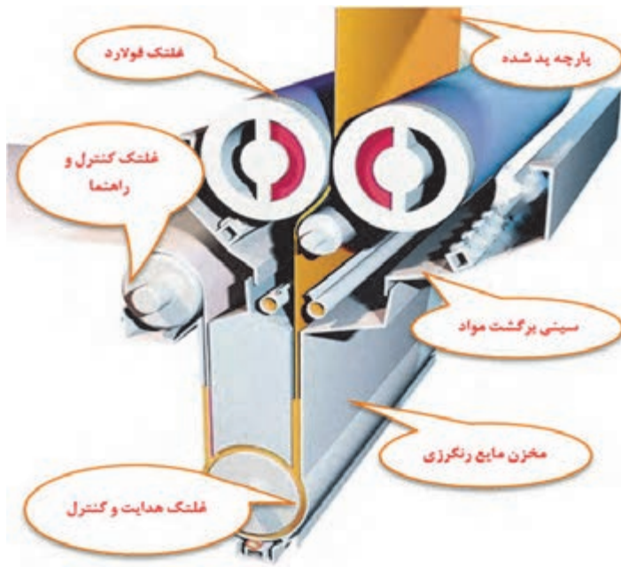
شکل ۱۲ قسمت‌های اصلی یک ماشین فولارد شامل جفت غلتک فولارد یا فشار
