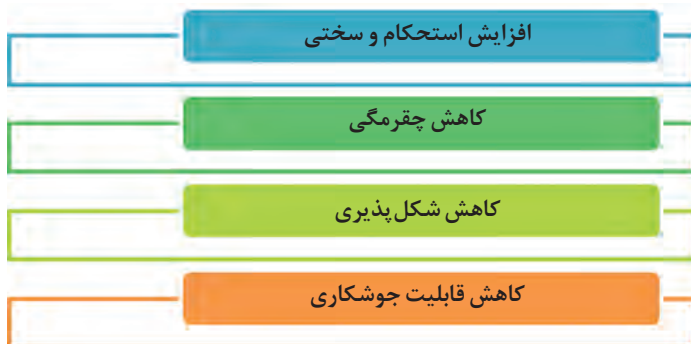
نمودار ۹- اثر افزودن کربن بر خواص فولاد
