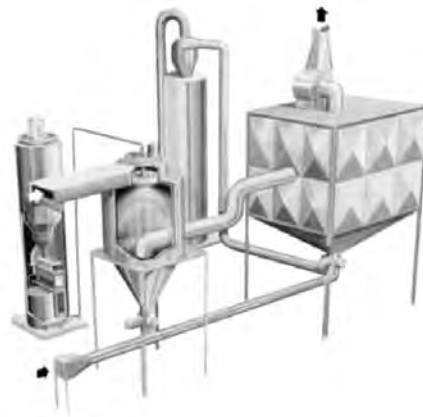
شکل ۱۸- سیستم سایش نیوماتیکی برای احیای ماسه به روش خشک
