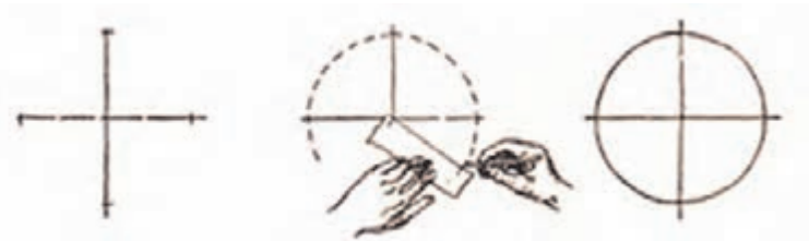
۲. به کمک نشانه‌گذاری روی قطرها (شکل ۳-۱۴).
