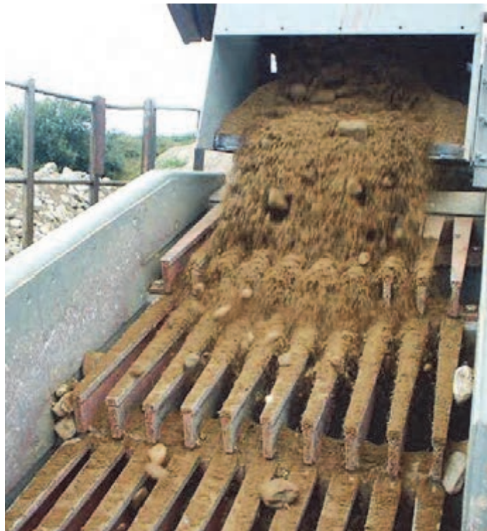
فیدر (تغذیه‌کننده) و سرند گریزلی سنگ‌شکن فکی
