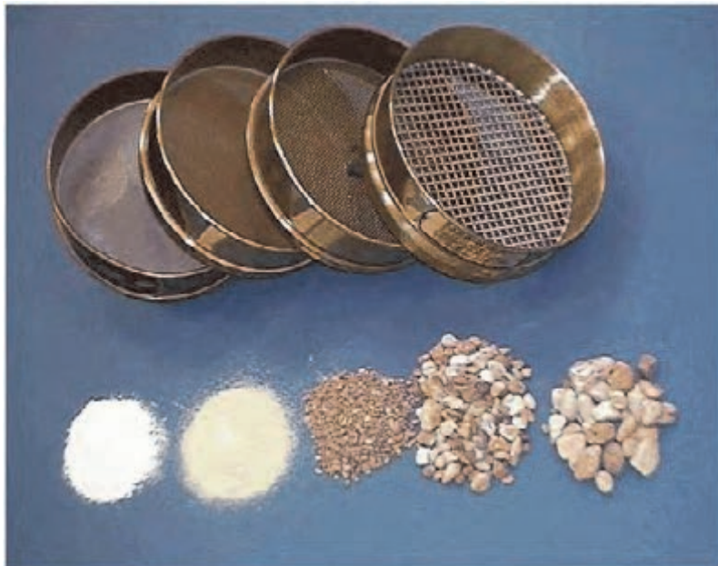
سرندهای دستی استاندارد آزمایشگاهی
