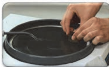
۷- صیقل دادن یک طرف نمونه تا رسیدن به حد مطلوب
