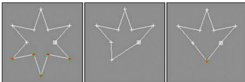
شکل ۱-۱۰۲ استفاده از دکمه‌های Fuse و Weld، چند رأس را در شکل ستاره ترکیب کرده است.
