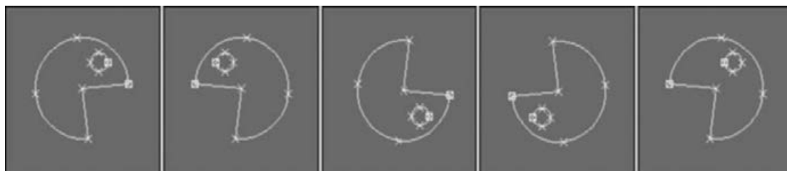
شکل ۱۱۱-۱ قرینه‌سازی یک شکل به سادگی انتخاب جهت و کلیک کردن دکمه Mirror است.
