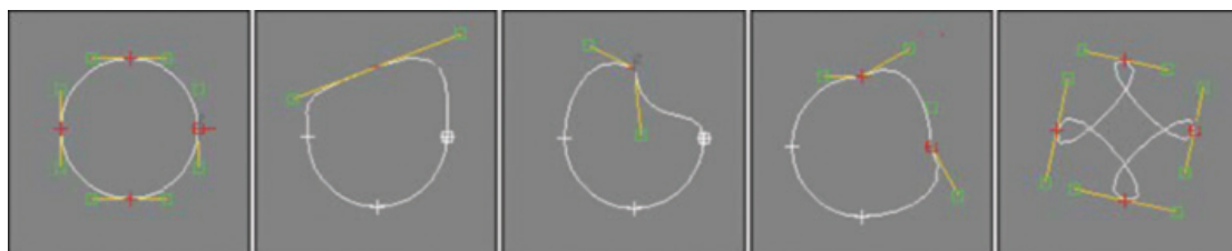
شکل ۱۰۱-۱. جابه‌جا کردن دستگیره‌های رئوس موجب تغییر Spline حول رأس می‌شود.
