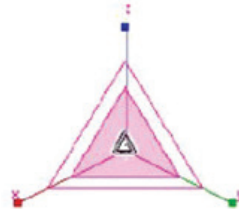
شکل ۱-۳۳- گیزموی Scale برای تغییر مقیاس یکنواخت
