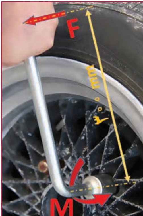
شکل ۱۰-۵- باز کردن پیچ چرخ خودرو توسط آچار چرخ
