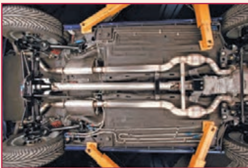
شکل ۵-۳۱- میل گاردان بارگذاری پیچشی را برای انتقال گشتاور تحمل می نماید.
