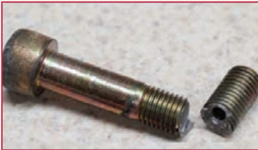
شکل ۵-۳۰- یک پیچ بریده شده بر اثر بارگذاری پیچشی
