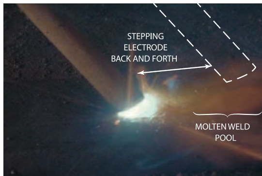
شکل ۴-۵۳- الکتروود به آرامی به سمت جلو می‌رود و دوباره به حوضچه جوش بر می‌گردد.
