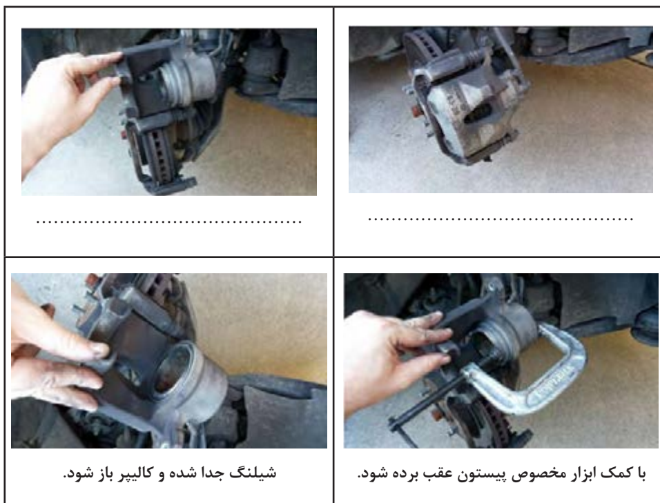
شکل ۳۳- مراحل باز کردن کالیپر ترمز
