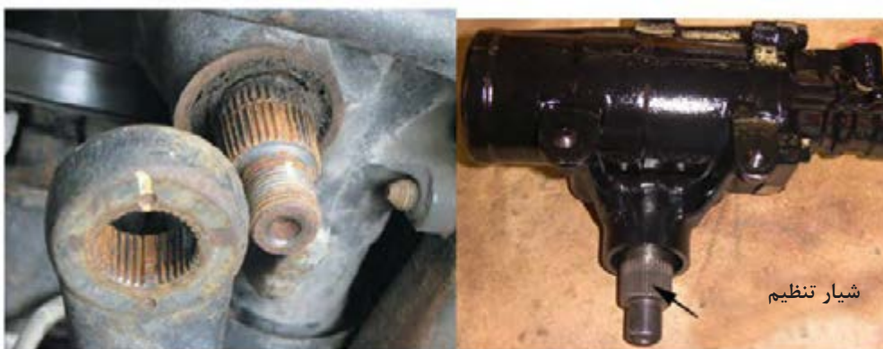
شکل ۳۲- هزار خار محور خروجی جعبه فرمان
