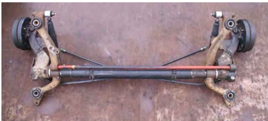
شکل ۴۱- مجموعه تعلیق عقب با فنر پیچشی
