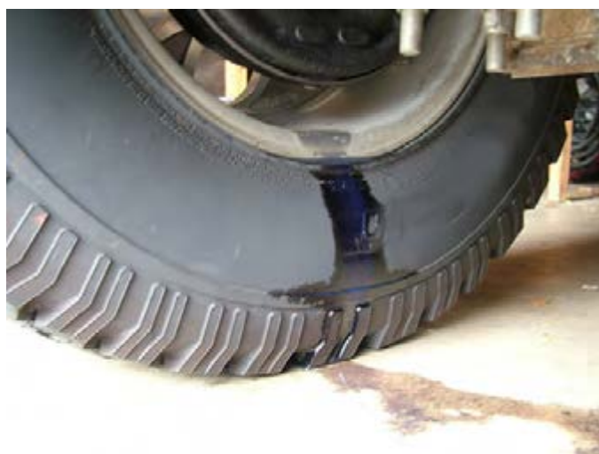
شکل ۴۱- وجود مایع اطراف چرخ عقب
