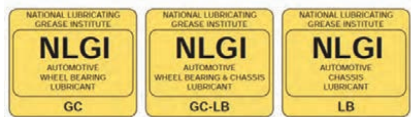
شکل ۱۲- برخی نمادهای گریس مورد استفاده در خودرو
