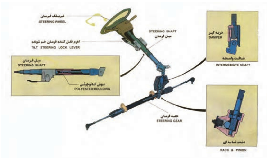
شکل ۲ - مجموعه فرمان و اجزای آن
