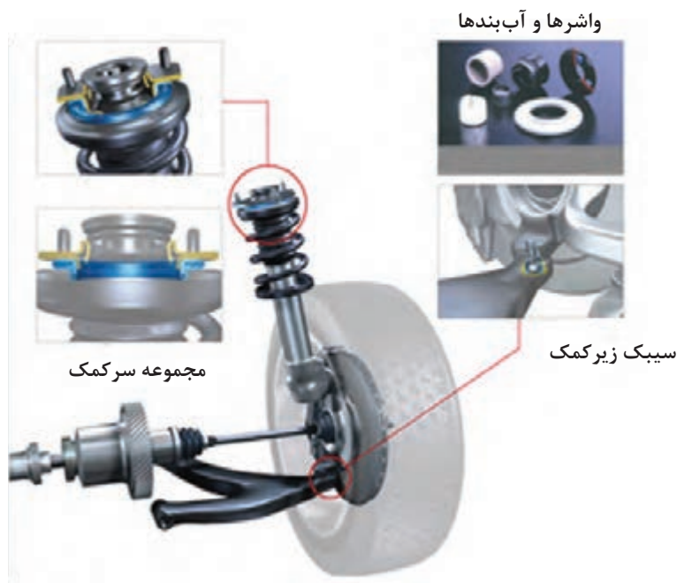
شکل ۳۲- برخی نقاط قابل تعمیر تعلیق مک فرسون
