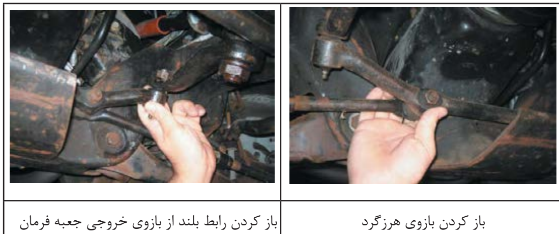
ادامه شکل ۳۰- باز کردن مجموعه اهرم بندی فرمان
