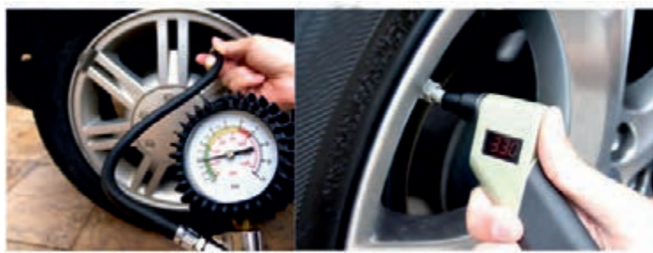
شکل ۲۱- شیوه بررسی و تنظیم فشار باد تایر
