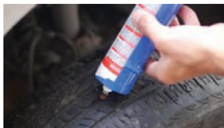
شکل ۲۷- مراحل پنچرگیری تایر بدون تیوب
