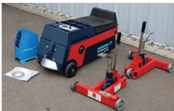
شکل ۲۴- نوعی دستگاه بالانس درجا چرخ
