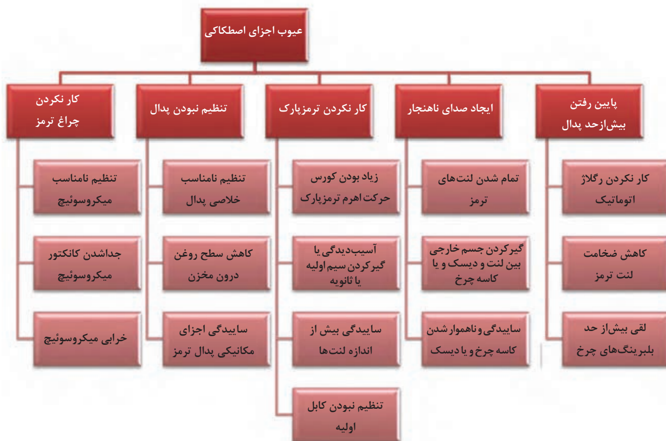
شکل ۲۳- عیوب اجزای اصطکاک‌سیستم
