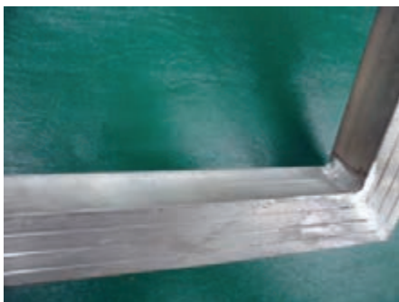
شکل ۵-۶ قاب با مقطع مستطیل
