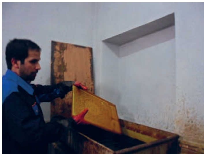
شکل ۴-۴۶- حرارت دادن کلیشه
