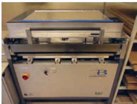
شکل ۱۷-۲ دستگاه قید کپی با نوردهی از پایین
