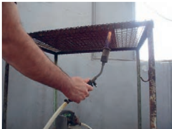
شکل ۴۷-۴- حرارت دادن کلیشه
