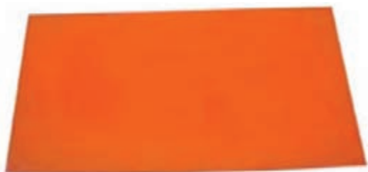
شکل ۴-۸- کلیشه خام فتوپلیمر
