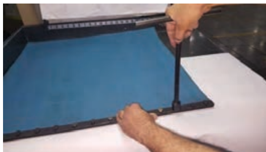
شکل ۶۰- نصب گیره لاستیک
