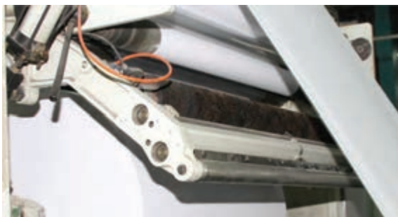
شکل ۱۰- اجزای سیستم اسپلیسر
