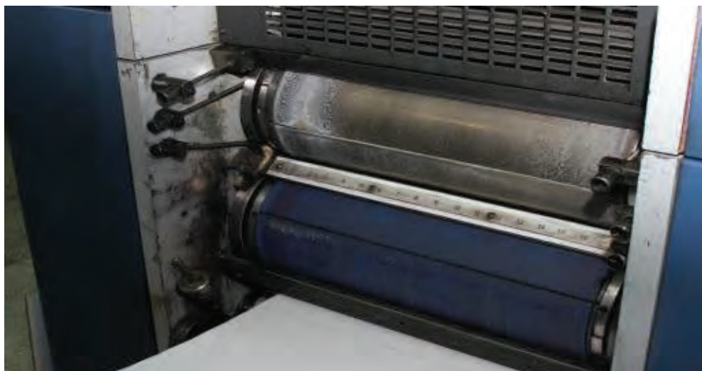
شکل ۶۸- سیلندر آماده بستن پلیت
