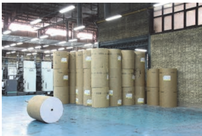
شکل ۱- حالت درست قرار گرفتن رول‌های کاغذ
