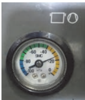
شکل ۴۳- گنج مکش صفحه متحرک نشان
