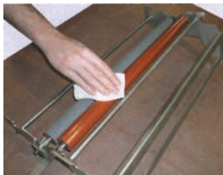
شکل ۳۰ - تمیز کردن نوردهای فیوزر
