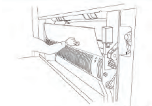
شکل ۷۳- نصب آستراگون به وسیله پلیت
