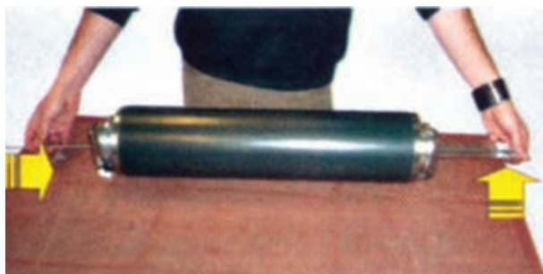
شکل ۲۱- عبور لامپ‌ها و سیم‌های آنها از داخل نورد
