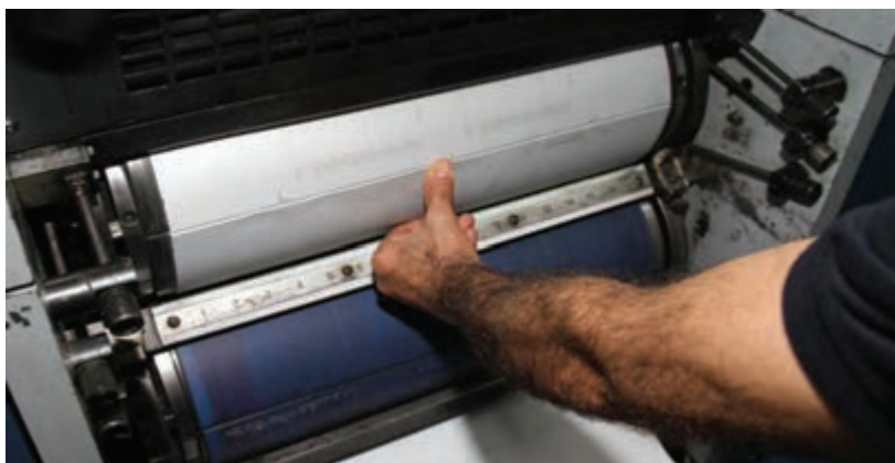
شکل ۷۱- قرارگیری ته کار پلیت در شیار سیلندر
