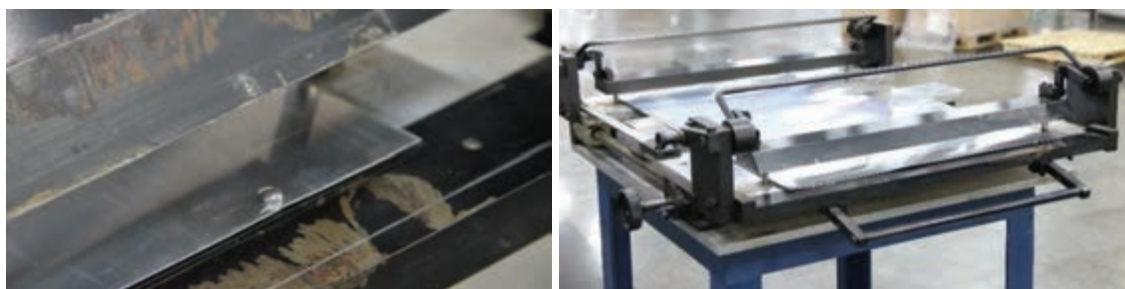
شکل ۶۴- قرار گرفتن پین در داخل پانچ
