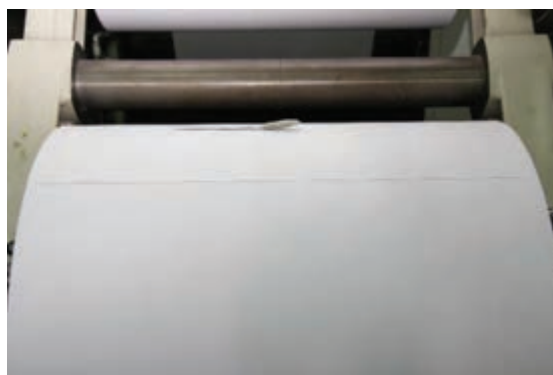
شکل ۱۸- لبه گونیا شده رول
