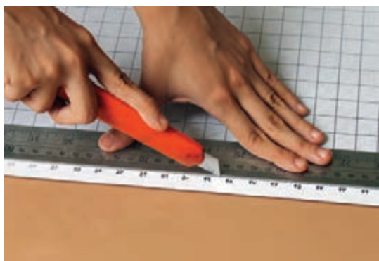
شکل ۴۰-۱- روش برش لبه اضافی کاغذ با کاتر
