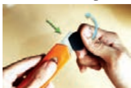
شکل ۱-۱۱- روش شکستن تیغه کاتر
