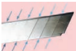
شکل ۱-۸- شیارهای روی تیغه کاتر
