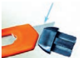
شکل ۱-۱۰- روش شکستن تیغه کاتر با قطعه انتهایی دسته آن
