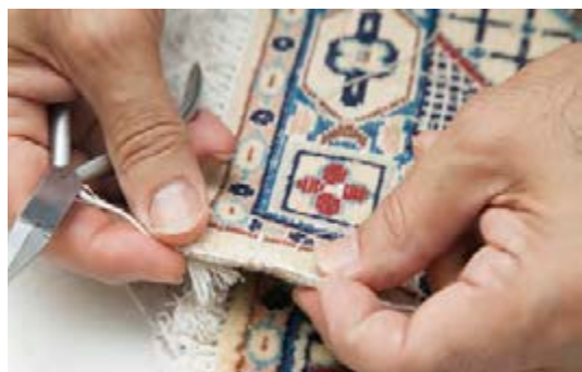
▲ تصویر ۴۵ - تنظیم کشش نخ هنگام دوخت
