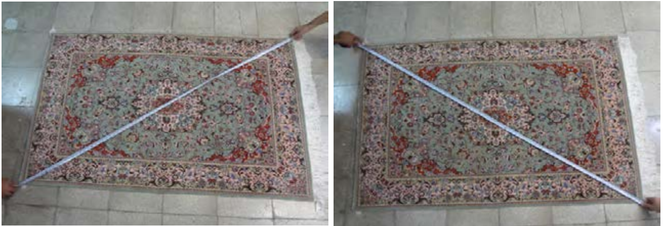
تصویر ۹- اندازه‌گیری قطرهای قالی با متر ▲
