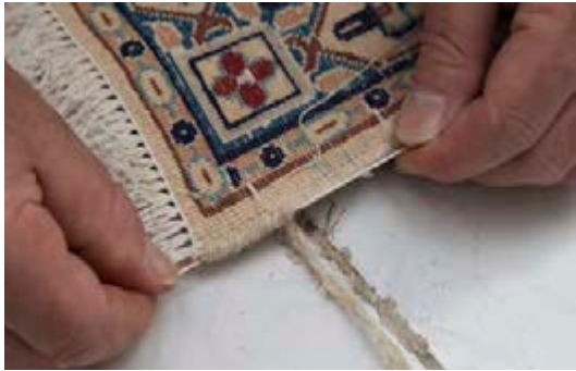
تصویر ۴۶- مراحل پیچیدن شیرازه بر لبه دوخته شده ▲
