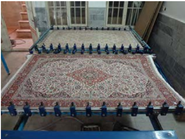
تصویر ۲۳- کشش عرضی فرش و خشک کردن به وسیله کباب پز مرحله ۷ ▲
