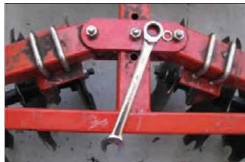
شکل ۲۸-۴- تغییر زاویه استقرار ردیف بشقاب‌ها روی شاسی
