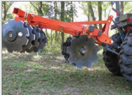
شکل ۲۹-۴- مالبند بلند و اتصال سه نقطه
