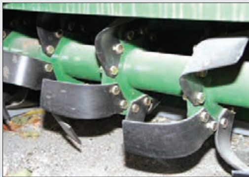
شکل ۲۲-۴- وضعیت درپوش و تیغه‌ها در گاوآهن دوار
