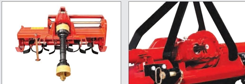
شکل ۲۵-۴- گاردان و محور توان‌دهی
