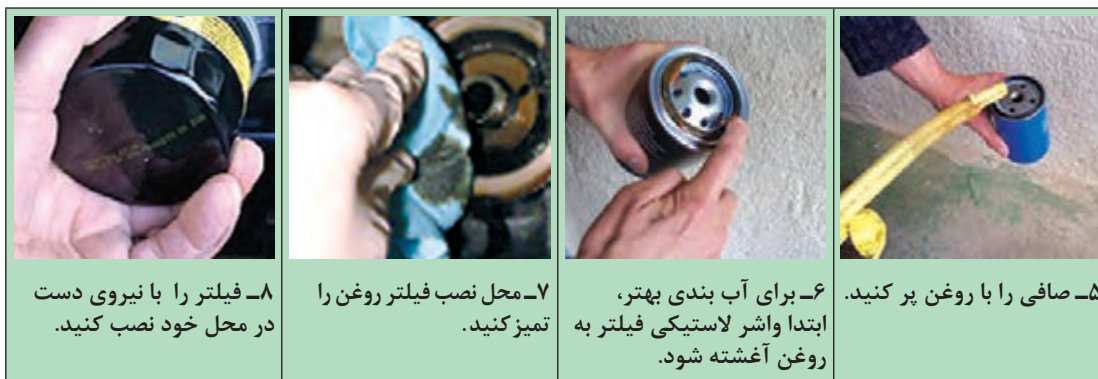
شکل ۵۰-۱- مراحل تعویض صافی روغن
