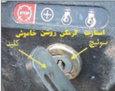
شکل ۱۴-۱ سوئیچ و وضعیت‌های آن
