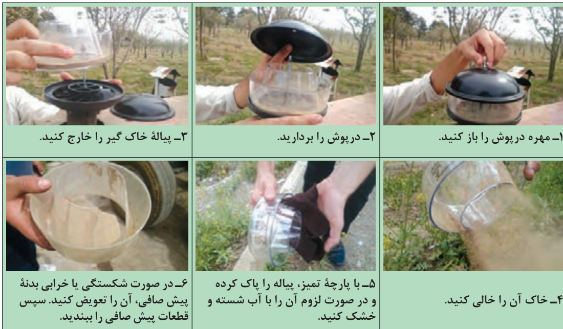
شکل ۳۱-۱- مراحل تمیز کردن پیش صافی
