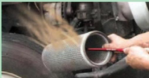
شکل ۳۵-۱- تمیز کردن صافی خشک با فشار هوا
