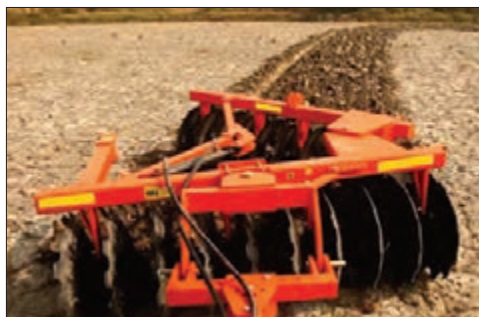
شکل ۲۸-۴- تغییر زاویه استقرار ردیف بشقاب‌ها روی شاسی
