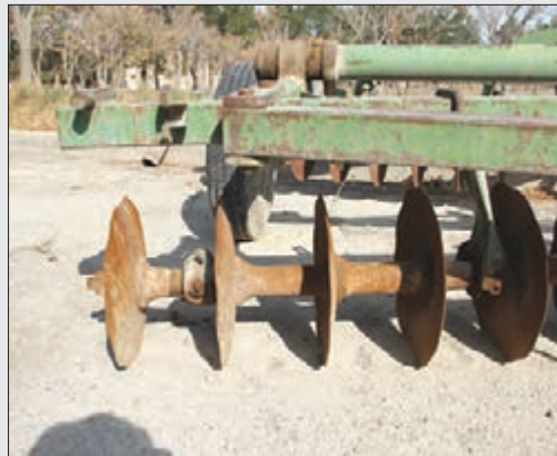
شکل ۱۹-۴- یاتاقان خراب بشقاب
