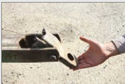
شکل ۱۸-۴- شکستگی نقطه اتصال و بشقاب
