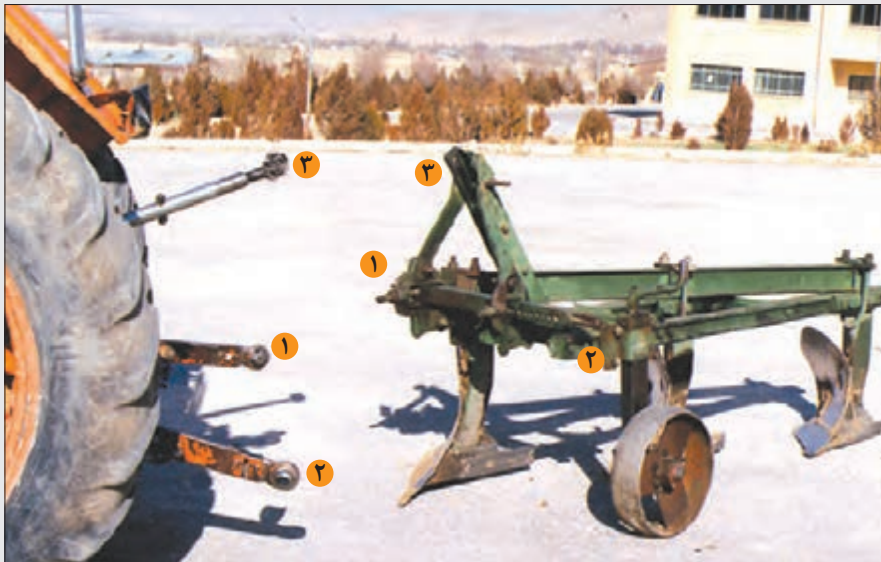
شکل ۲۸-۳- اتصال گاواهن به تراکتور
