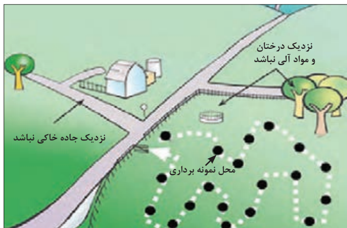
شکل ۱۱-۲- تعیین محل نمونه برداری
