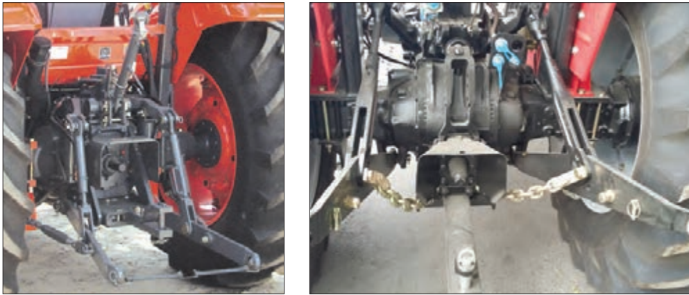
شکل ۳۲-۳- زنجیر تنظیم تعادل یا نوسان گیر
