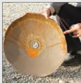
شکل ۱۸-۴- شکستگی نقطه اتصال و بشقاب
