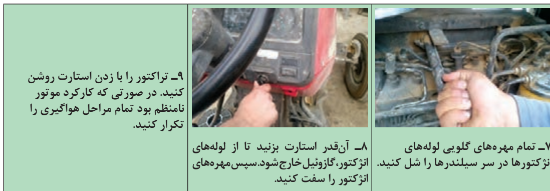
شکل ۴۰-۱- مراحل هواگیری سیستم سوخت رسانی
