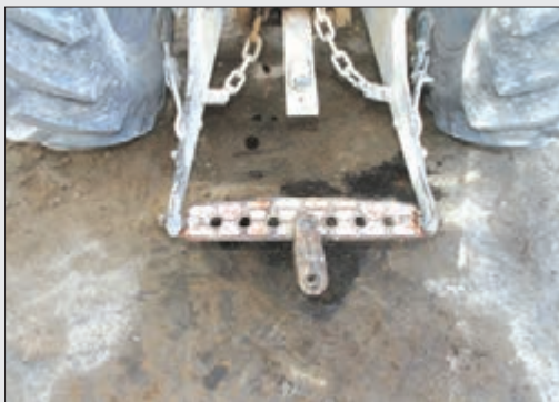
شکل ۲۹-۴- مالبند بلند و اتصال سه نقطه
