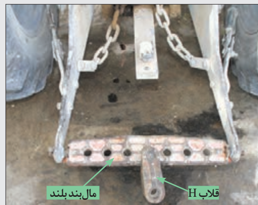
شکل ۱۵-۵- مال‌بند بلند برای اتصال ماشین هموارکننده نیمه‌سوار
