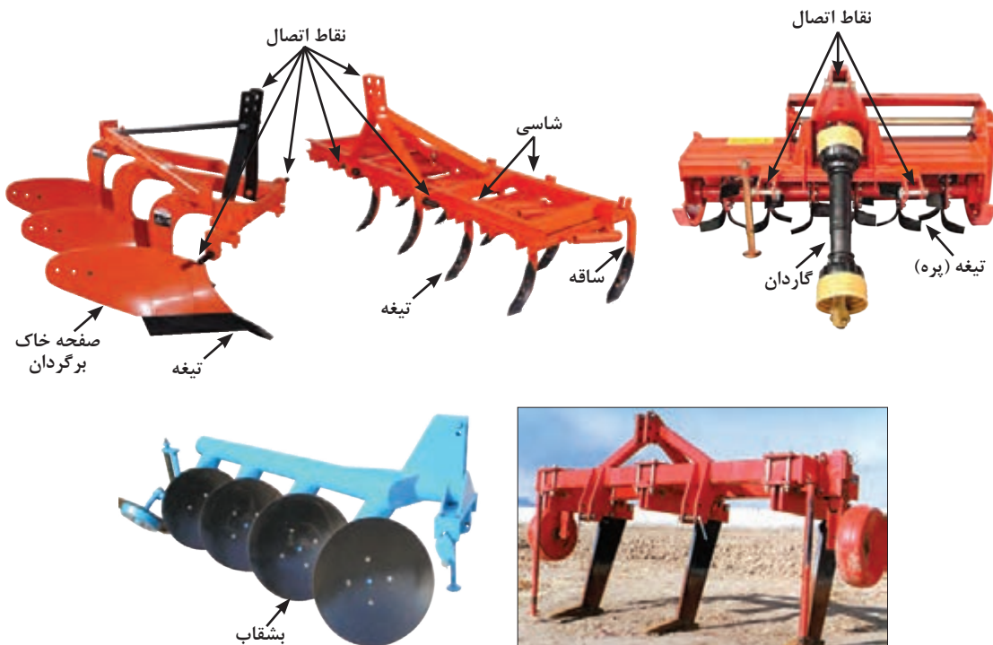
شکل ۱۹-۳- انواع گاوآهن‌ها و نمایش ساختار کلی آن
