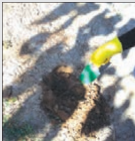
شکل ۲-۲- برداشت نمونه خاک برای تعیین رطوبت خاک
