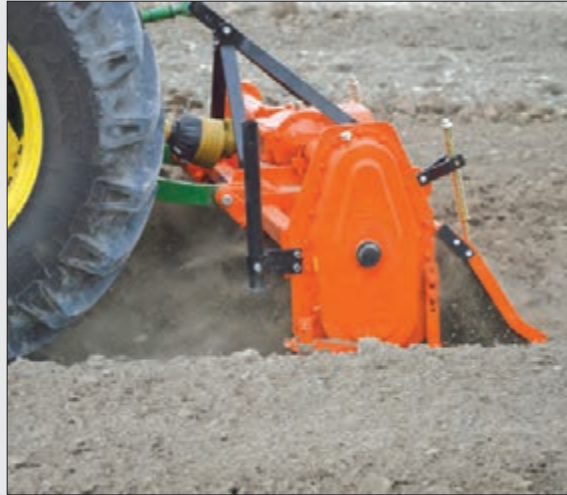
شکل ۳۴-۴- تنظیم درپوش و عمق کار
