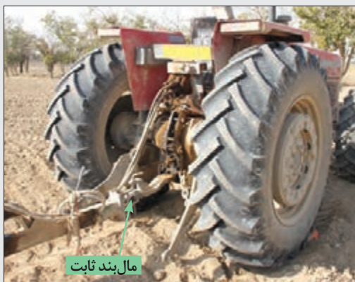
شکل ۱۶-۵- نقطهٔ اتصال در صاف‌کننده کششی
