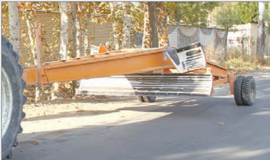
شکل ۱۹-۵- زمین‌صاف‌کن در وضعیت جابه‌جایی
