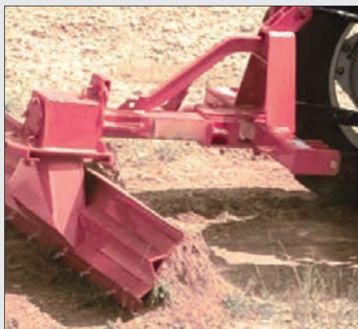
شکل ۲۶-۲ تیغه پشت تراکتوری متصل به تراکتور
