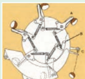
شکل ۷- تصویر شماتیک نحوه کار موزع انگشتی
