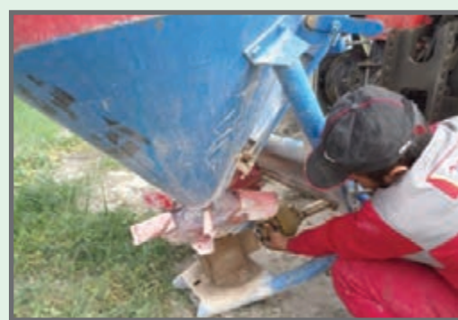
شکل ۱۰- نصب گاردان بین بذریاش و تراکتور
