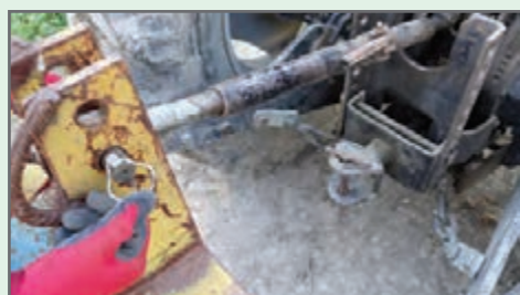
شکل ۲۳- اتصال بازوی وسط تراکتور به نه‌رکن
