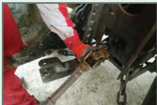
شکل ۱۰- نصب گاردان بین بذریاش و تراکتور
