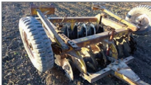
شکل ۴- دیسک آفست کششی
