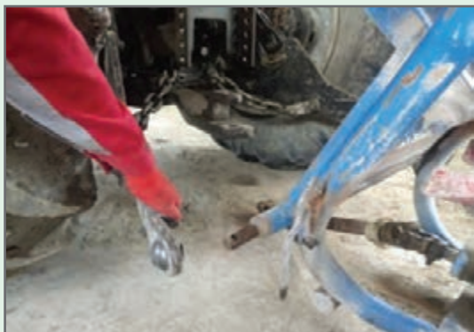
شکل ۹- اتصال بذریاش به بازوهای کناری تراکتور
