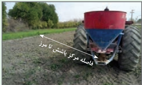
شکل ۲۰- کنترل فاصله پاشش بذر
