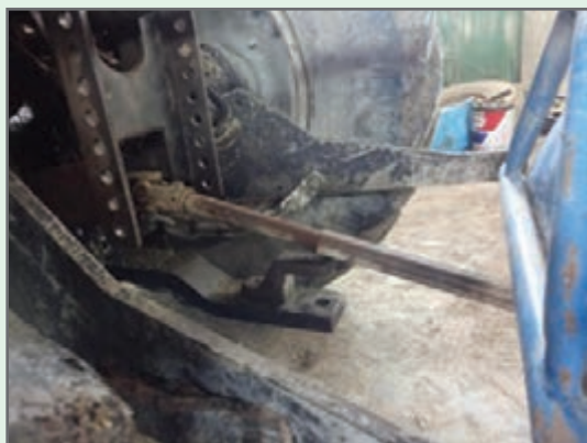
شکل ۸- کنار زدن مالبند ثابت
