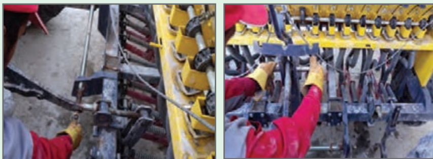
شکل ۱۳- متصل کردن خطی کار به تراکتور
