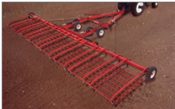
شکل ۶- هرس دندان میخی
