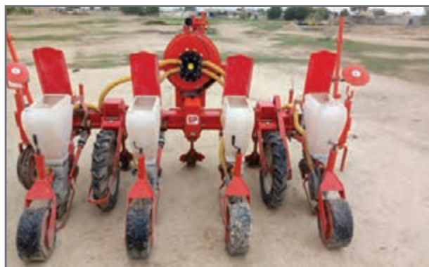
شکل ۲- ردیف‌کار پنوماتیکی (با حذف بخش کودکار)
