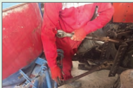
شکل ۱۱- اتصال بازوی وسط تراکتور به بذریاش
