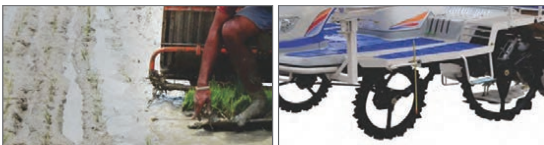
شکل ۲۷- مارکر نشاکار راه رونده
