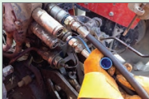
شکل ۱۱- اتصال دیسک کششی هیدرولیکی
