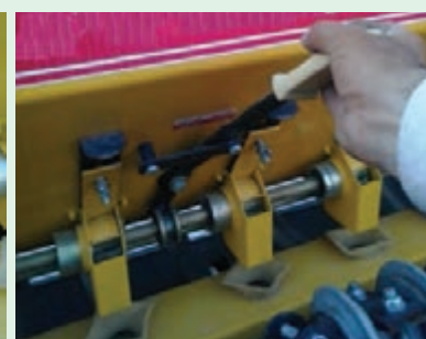
شکل ۵۸ - بخشی از تنظیمات که قبلاً انجام شده، در شروع عملیات کاشت، واریسی می‌گردد
