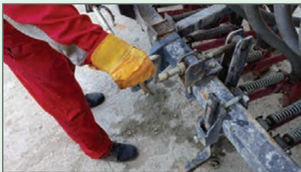
شکل ۲۱- تنظیم عمق کاشت
