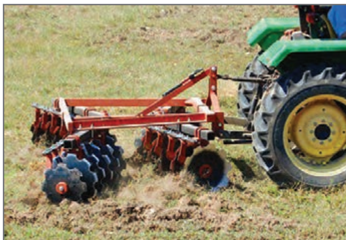
شکل ۳- دیسک دو زانویی سوار
