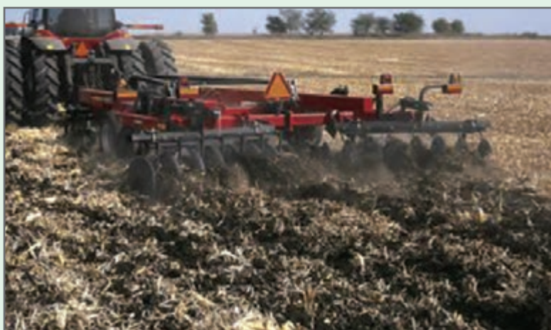
شکل ۳۲- نمونه ماشین مرکب خاک‌ورزی
