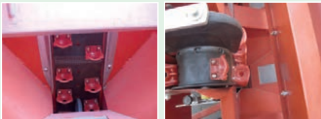
شکل ۱۶- موزع پیاله‌ای یک و دو ردیفه
