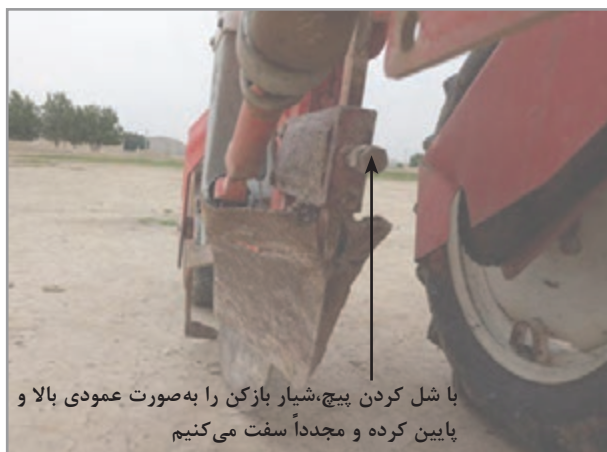
شکل ۲۰- تنظیم شیار بازکن
