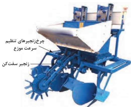
شکل ۱۱- زنجیر و چرخ زنجیر سیستم محرک موزع سبب زمینی کار
