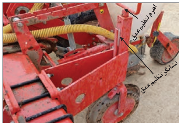
شکل ۱۸- تنظیم عمق کاشت
