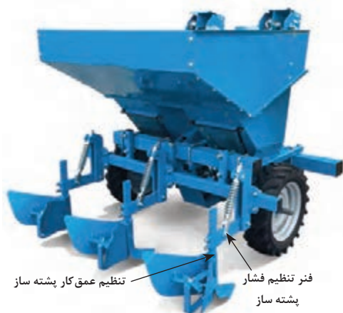
شکل ۱۲- تغییر موقعیت چرخ تثبیت عمق کاشت سبب زمینی کار
