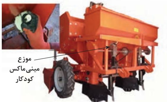
شکل ۱۵- تنظیم موزع مینی ماکس کودکار
