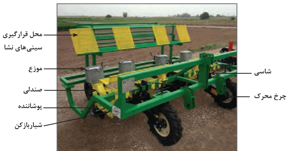
شکل ۴- اجزای ساختمانی یک نمونه نشاکار صیفی
