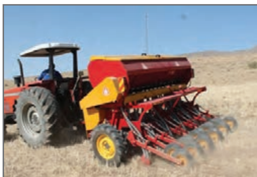
شکل ۳۵- کودکار بذرکار کشت مستقیم دیم مدل شاهین ۲۵۰۰
