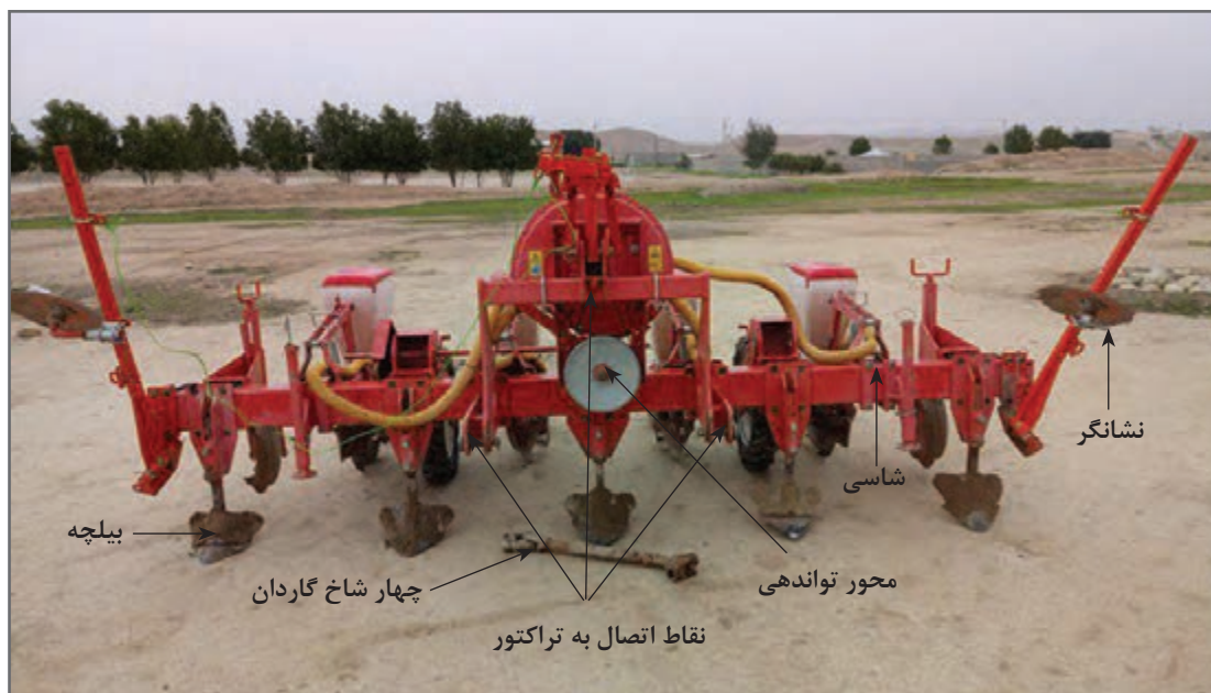
شکل ۶- ساختمان ردیف‌کار پنوماتیکی بدون کودکار از جلوی دستگاه
