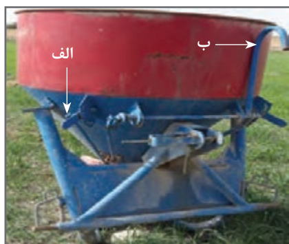
شکل ۱۹- اهرم‌های تنظیم بذر
