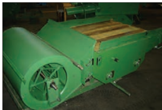
شکل ۲۳- واحد تمیز کننده
