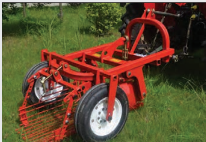
شکل ۱۳- اتصال سیب زمینی کن لرزان به تراکتور
