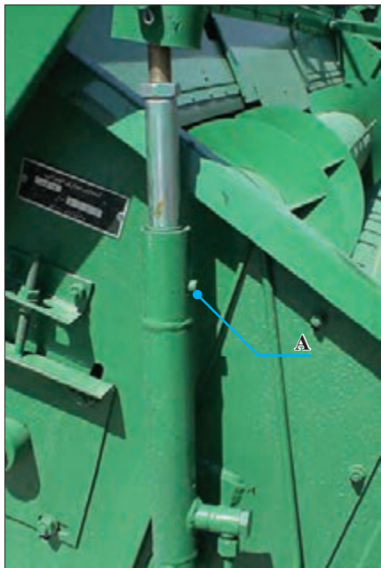
شکل ۴۲- جک هیدرولیک تنظیم ارتفاع چرخ و فلک
