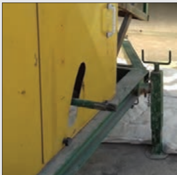
شکل ۳۸- پایه نگهدارنده ماشین بوجاری تراکتوری
