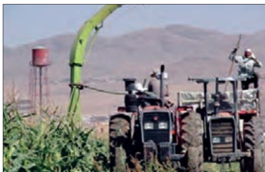
شکل ۳۲- تناسب لوله تخلیه با ماشین حمل
