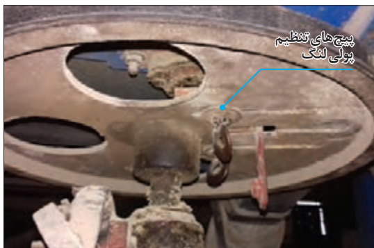
شکل ۳۴- پیچ تنظیم کورس غربال کابلی
