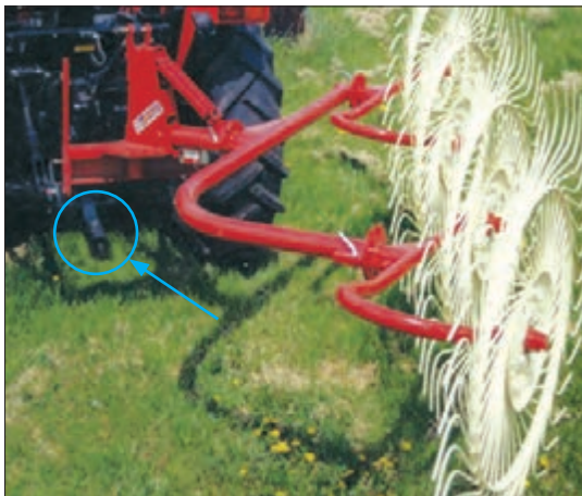
شکل ۵۹- اتصال شانه خورشیدی به تراکتور
