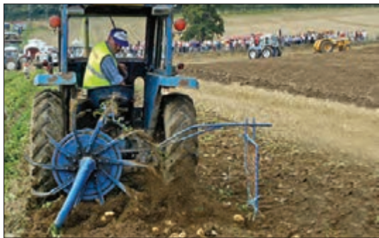
شکل ۹- سیب‌زمینی‌کن دوار در حال کار
