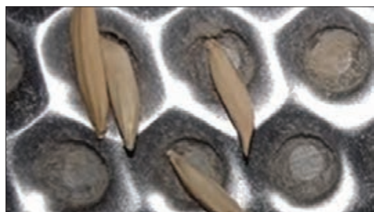
شکل ۱۶- قرار گرفتن دانه‌ها در سوراخ‌های استوانه حفره‌دار
