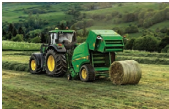
ب) بسته‌بند استوانه‌ای
