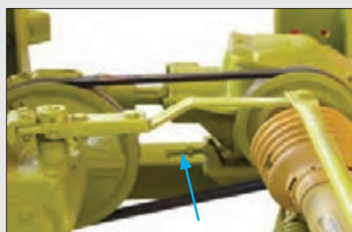
شکل ۵۰- پیچ تنظیم کشش تسمه
