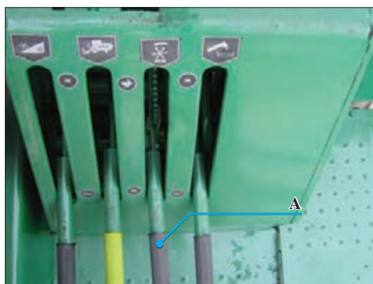
شکل ۳۹- اهرم تنظیم سرعت پروانه چرخ و فلک
