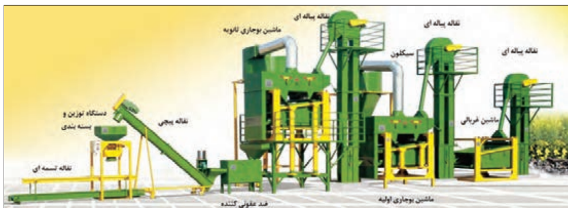
ج) خط کامل بوجاری دانه های روغنی (کلزا و...)
