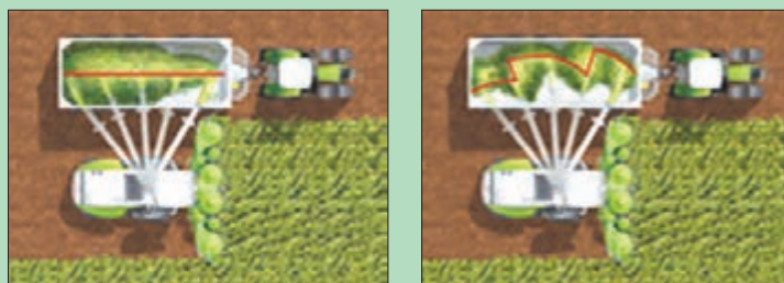
شکل ۶۰- کنترل اتوماتیک لوله تخلیه در چا پرهای جدید
