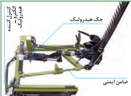
شکل ۱۷- دروگر شانه‌ای با سیستم محرک ارتعاشی
