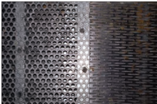
شکل ۳۱- دو نمونه غربال با سوراخ‌های متفاوت
