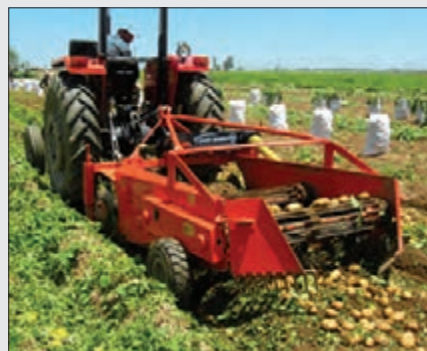
شکل ۱۷- برداشت سیب‌زمینی با سیب‌زمینی‌کن نقاله‌ای
