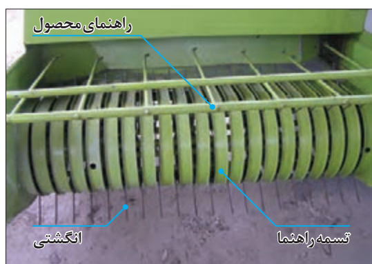
شکل ۷۲- اجزای واحد بردارنده بسته‌بند
