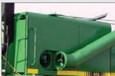
شکل ۳۴- قرار دادن لوله تخلیه کمباین در محل مخصوص حمل و نقل
