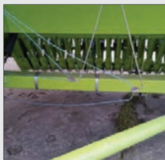
شکل ۹۱- مسیر نخ کردن بسته‌بند و جایگاه سوزن
