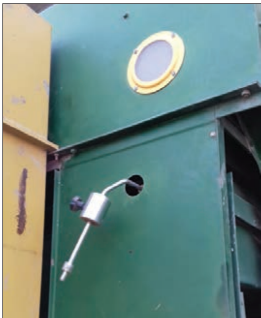
شکل ۳۳- وزنه تنظیم ضربه زن غربال بالایی
