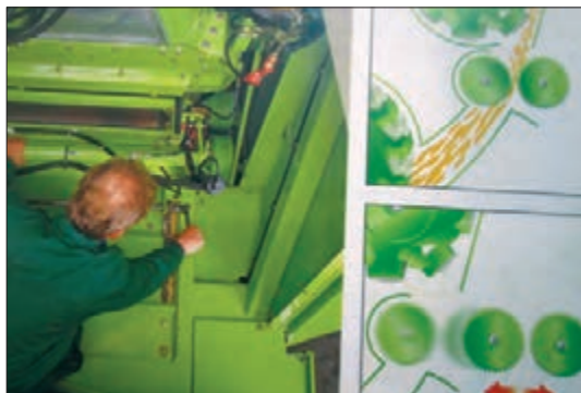
شکل ۲۱- خارج کردن بلال خردکن از مدار
