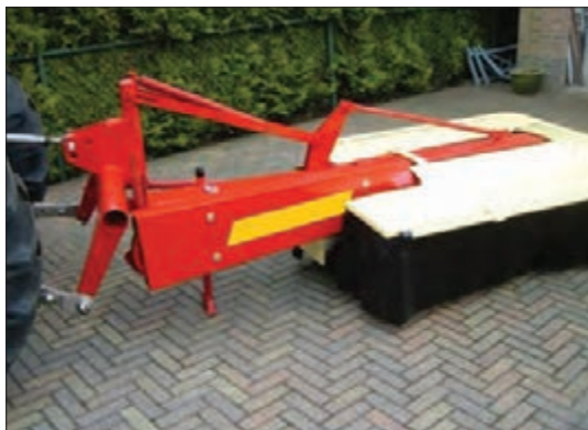
شکل ۲۹- دروگر در وضعیت حمل و نقل
