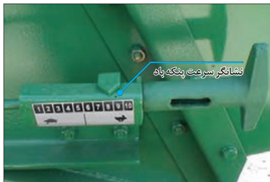
شکل ۴۴- اهرم تنظیم سرعت پنکه
