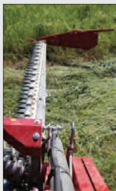
شکل ۳۳- دروگر شانه‌ای در دو وضعیت کار و حمل و نقل
