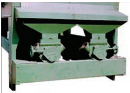
شکل ۳۶- تنظیم کننده‌های استوانه حفره‌دار
