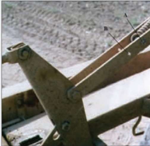
شکل ۳۷- تنظیم فنر شناور
