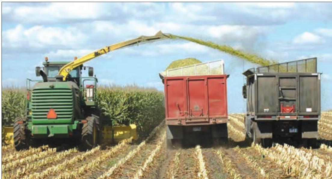
شکل ۶- برداشت ذرت به وسیله چاپر خودگردان
