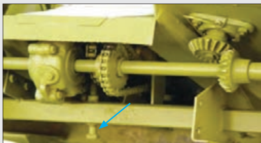
شکل ۵۱ - پیچ تنظیم زنجیر تیغه‌های درو
