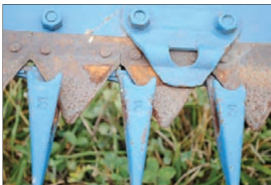
شکل ۱۰- موقعیت انگشتی و تیغه در دروگر شانه‌ای
