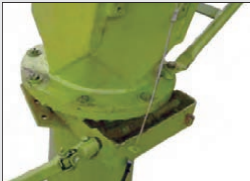
شکل ۴۰- چرخ دنده دوران لوله
