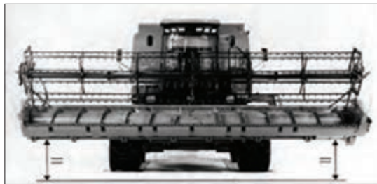
شکل ۳۷- اندازه‌گیری تراز بودن پلاتفرم
