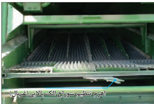
شکل ۲۴- الک بالایی تمیز کننده
