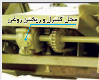
شکل ۴۷- جعبه دنده دوکفه ای
