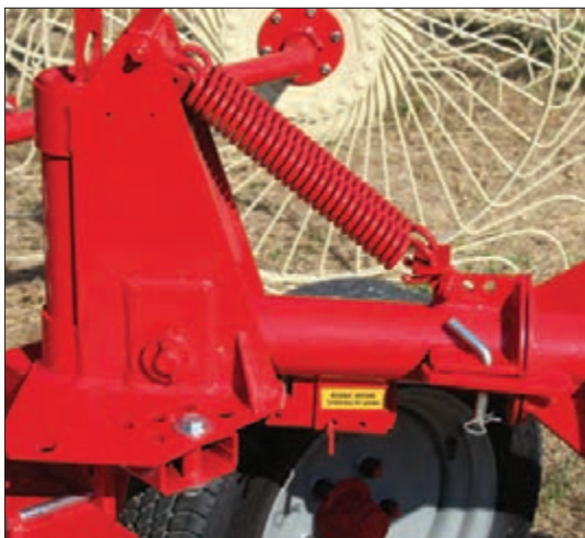
شکل ۶۰- فنرهای شناوری شانه خورشیدی
