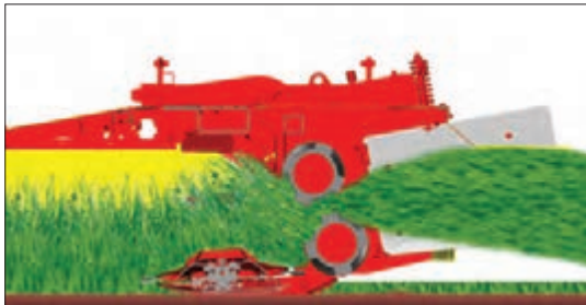
شکل ۵۶- دروساقه کوب و طرز کار آن
