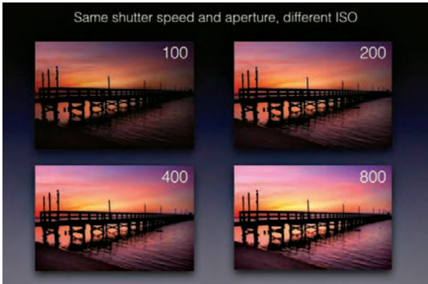
شاتر و دیافراگم ثابت و ISO متفاوت برای جبران کمبود نور در عکس
