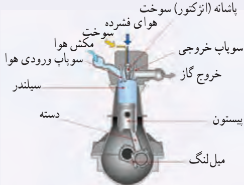
شکل ۵-۲۰ طرحی از اجزای یک ماشین دیزل
