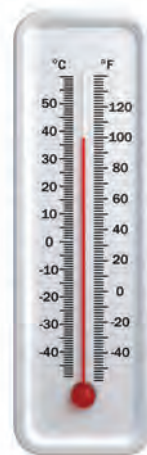
شکل ۱-۴ یک نمونه دماسنج الکلی
