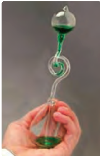
شکل ۴-۳۸ با در دست گرفتن حباب شیشه‌ای و گرم کردن آن، مایع رنگی در لوله ماریپج بالا می‌رود.
