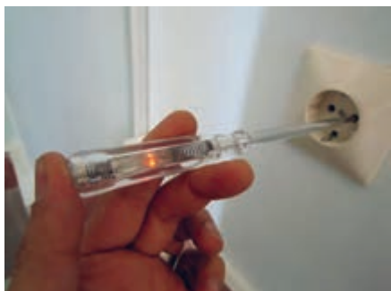
شکل ۴ - کاربرد صحیح فازمتر
