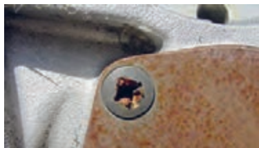
ب) استفاده ناصحیح از آچار پیچ گوشتی
