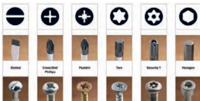
شکل ۱۸- انواع دیگر پیچ گوشتی
