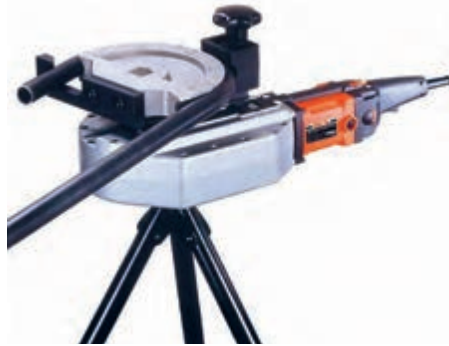
شکل ۱۷- خم کردن لوله
