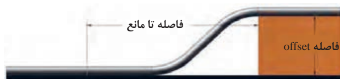
شکل ۳۵- هم‌راستا کردن امتداد لوله
