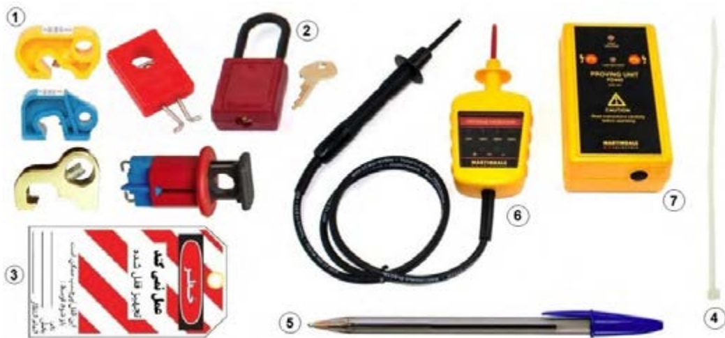
شکل ۵۱- تجهیزات لازم برای جداسازی ایمن
