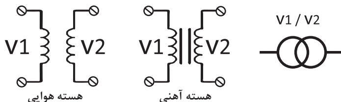
شکل ۳- علائم اختصاری ترانسفورماتور با هسته های مختلف
