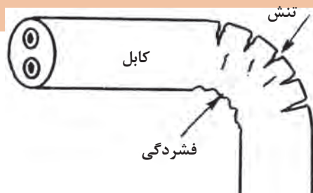
شکل ۲۳- تنش فشردگی خمش کابل
