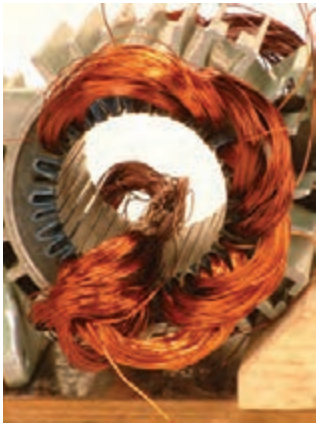
شکل ۶۹- درآوردن بازوهای ۱،۲،۳ برای قرار دادن کلاف آخر
