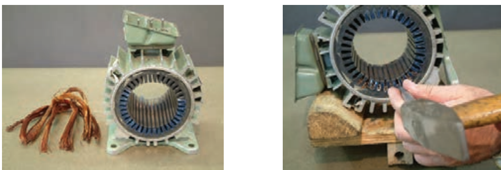
شکل ۲۴- سیم های خارج شده از شیارها
