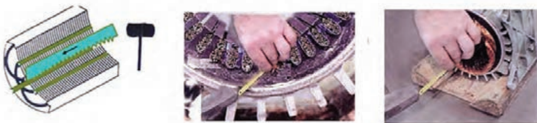
شکل ۲۳- خارج کردن پرسپان از شیار
