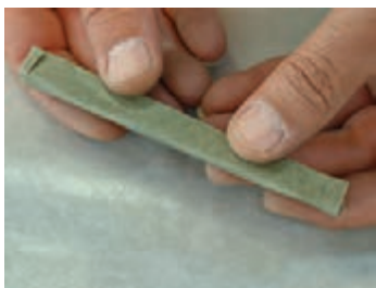
(ح) عایق آماده شده
