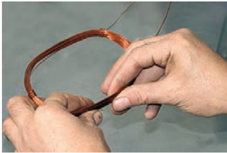
شکل ۳۸-۲ مرتب کردن سیم‌ها جهت کلاف گذاری
