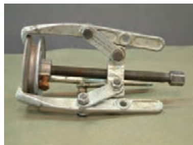
شکل ۱۷- در آوردن پولی از محور موتور
