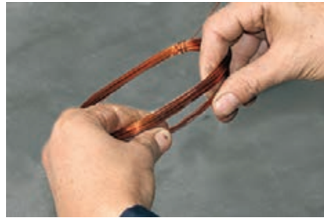
شکل ۳۸-۱ طریقه در دست گرفتن کلاف
