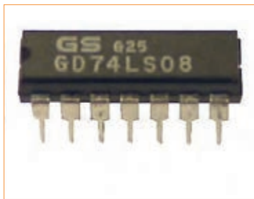
شکل ۶-۵۶- شکل ظاهری و اتصال داخلی پایه های آی سی ۷۴۰۸
