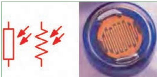
شکل ۹۵ — ۱ مقاومت تابع نور و نماد آن
