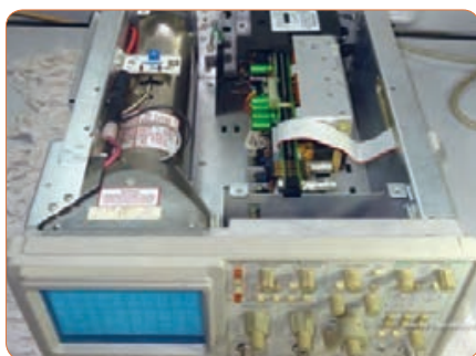
شکل ۵۲-۴- ساختمان داخلی یک نوع اسیلوسکوپ
