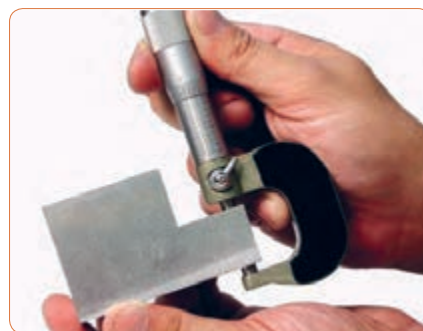
شکل ۱۶-۲ چگونگی در دست گرفتن میکرومتر
