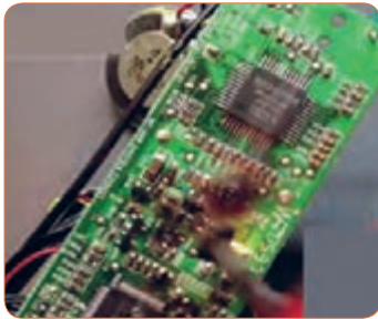
شکل ۵-۵ - قطعاتی از برد سوخته است.
