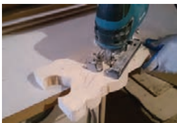
شکل ۱۹- قرارگیری تیغه داخل سوراخ مته
