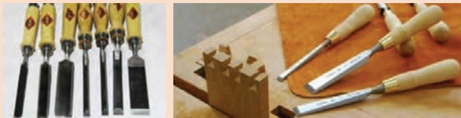
شکل ۲۱- انواع مغارها، برای ساخت اتصالات چوبی
