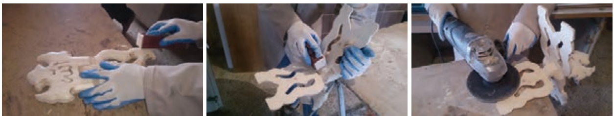
شکل ۲۷- عملیات پرداخت به وسیله سنباده دستی و سنباده دیسکی
