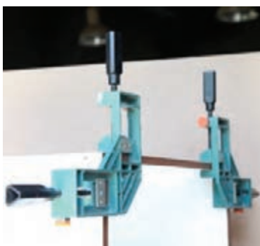
شکل ۵۲ - فیکس کردن قطعات
