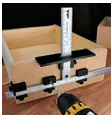
شکل ۱۳۴- چند نوع شابلون سوراخ کاری محل دستگیره
