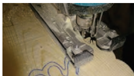
شکل ۱۶- انتقال طرح شابلون روی چوب
