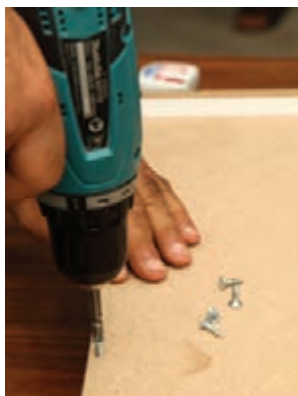
شکل ۵۶ - بستن کف جعبه با پیچ
