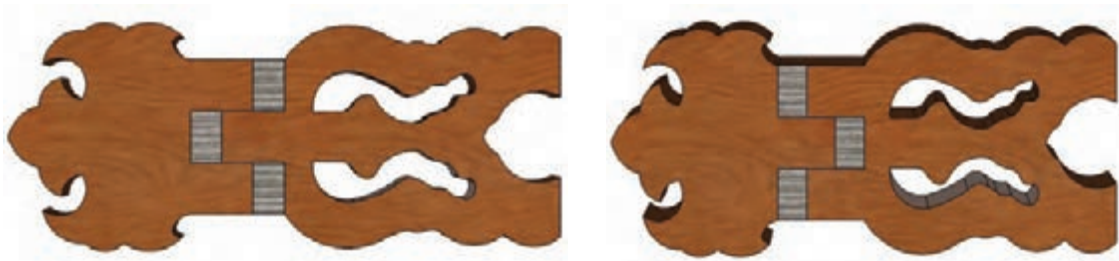
شکل ۲۰- تقسیم‌بندی خطوط عرضی رحل: پشت قطعه کار (سمت چپ) و جلو قطعه کار (سمت راست)
