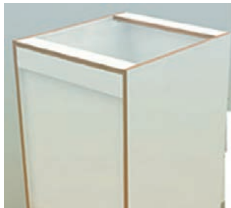
شکل ۲۸ - نصب یکی از قیده‌های فیتینگ پشت کابینت دیواری
