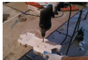
شکل ۱۸- عمل سوراخ کاری وسط رحل با دریل دستی
