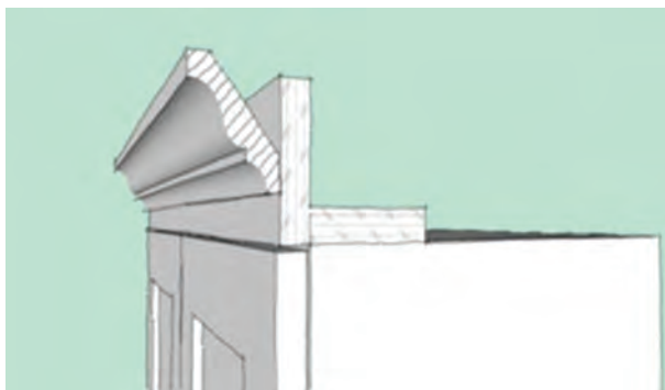
شکل ۳۵- روش نصب تاج در کابینت‌های چوبی
