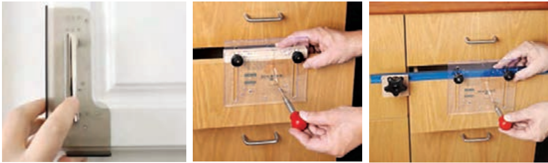
شکل ۱۳۵- چند نوع شابلون سوراخ کاری محل دستگیره
