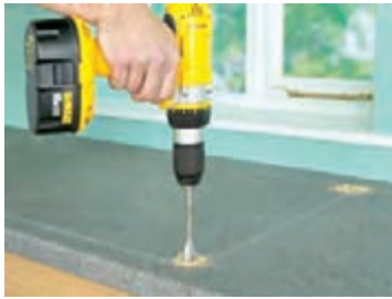
شکل ۱۰۰ - سوراخ کاری صفحه جهت عبور تیغه اره عمودبر
