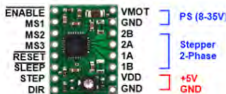
تصویر ۳۱- درایور استپ موتور A۴۹۸۸
