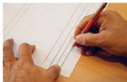
شکل ۳۹- کمک از لبه کاغذ
