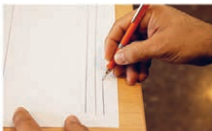
شکل ۴۰- کمک از لبه میز
