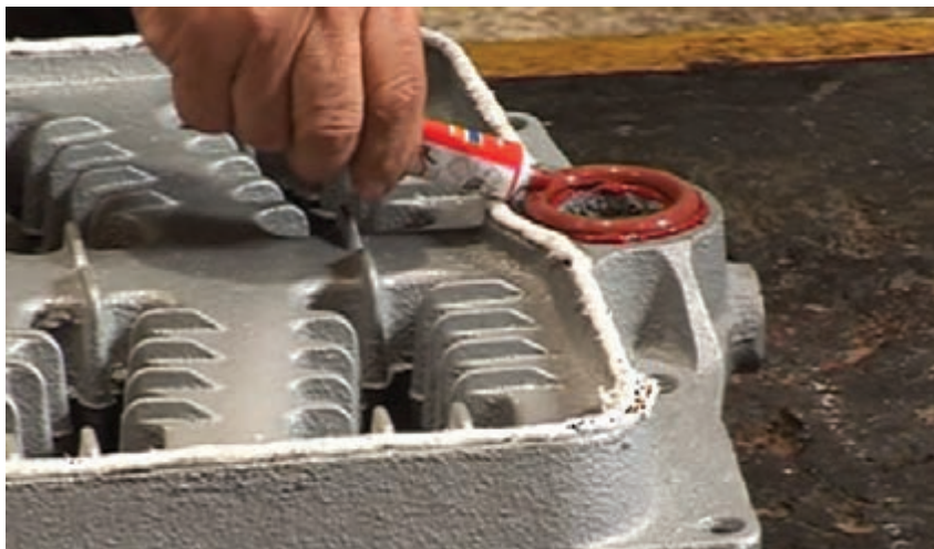
شکل ۲۰- استفاده از اورینگ به جای بوش
