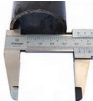
شکل ۴۸ - شاخک‌های داخل‌سنج کولیس
