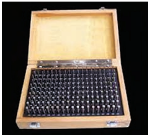
شکل ۵۴ - گیج بین و روش کنترل
