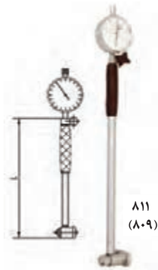
شکل ۵۱ - ابزار داخل‌سنج برای اندازه‌گیری سوراخ‌های کوچک
