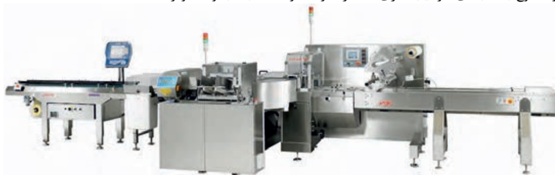
ماشین بسته‌بندی به روش اتمسفر اصلاح شده
